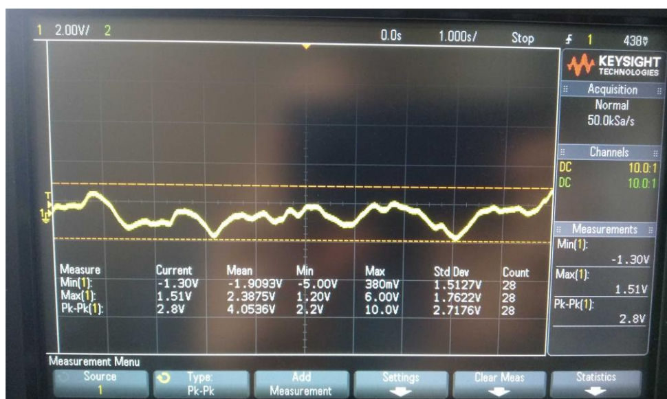
Obr. 26 Průběh šumového napětí naměřeného osciloskopem na výstupu předzesilovače pro levý kanál
