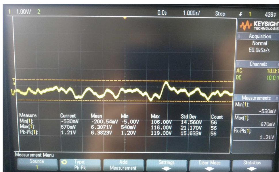
Obr. 28 Průběh šumového napětí naměřeného osciloskopem na anodě stupně A1 pro levý kanál
