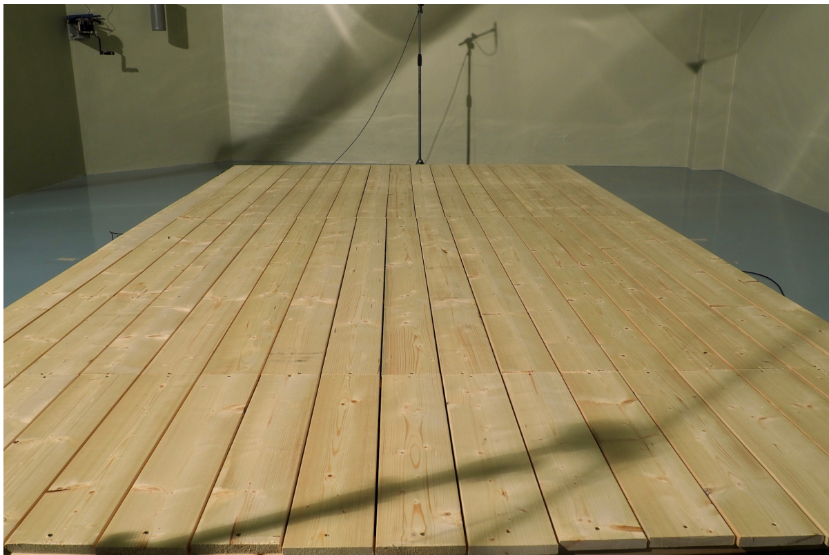
Obr. A.2: Rozložení čelních latí pro variantu mezery 4 mm
