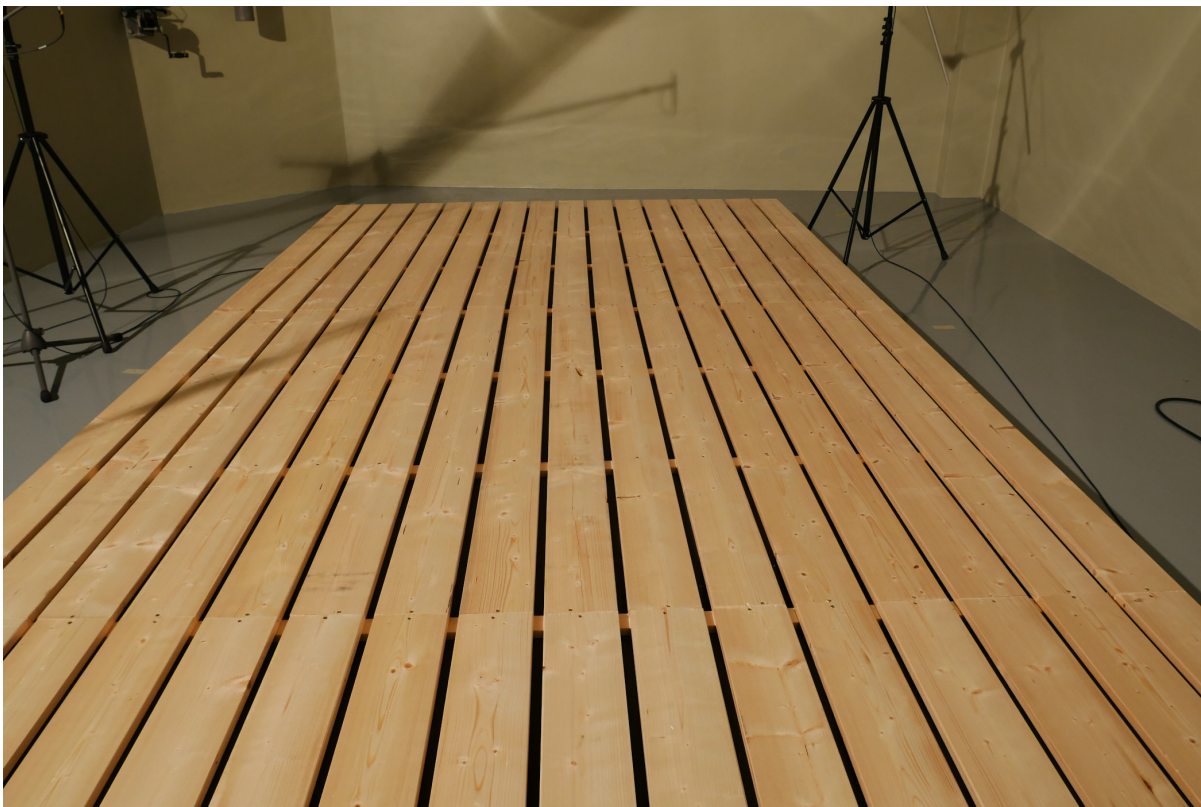
Obr. A.3: Rozložení čelních latí pro variantu mezery 19 mm
