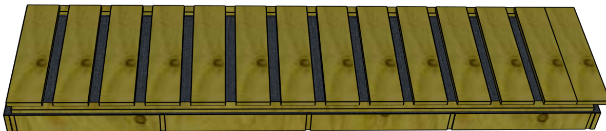
Obr. 5.3: Vizualizace jedné sekce modulárního systému s rozestupy čelních latí 44 mm
