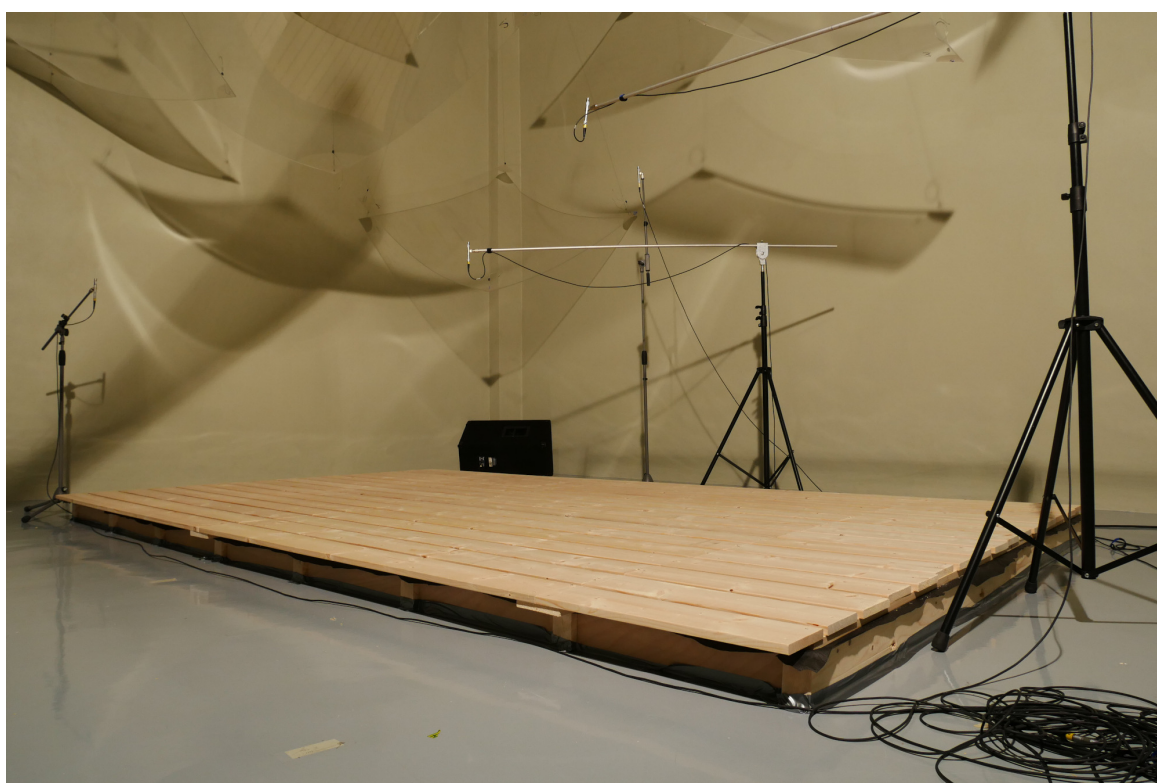
Obr. A.1: Celkový pohled na rezonátor umístěný v komoře
