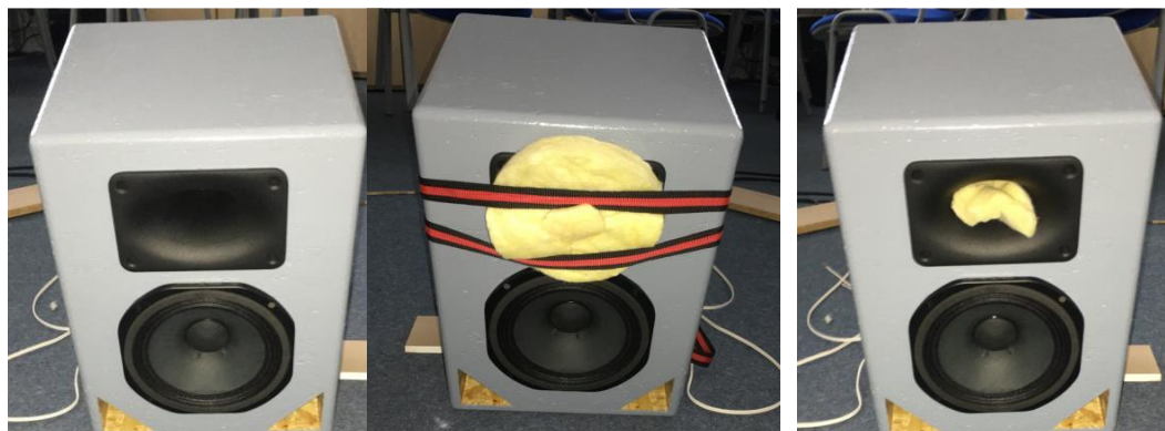
Obr. 26 Experiment se zakrytím zvukovodu: vlevo bez krytí, uprostřed zakrytý celý zvukovod, vpravo zakryté ústí zvukovodu
