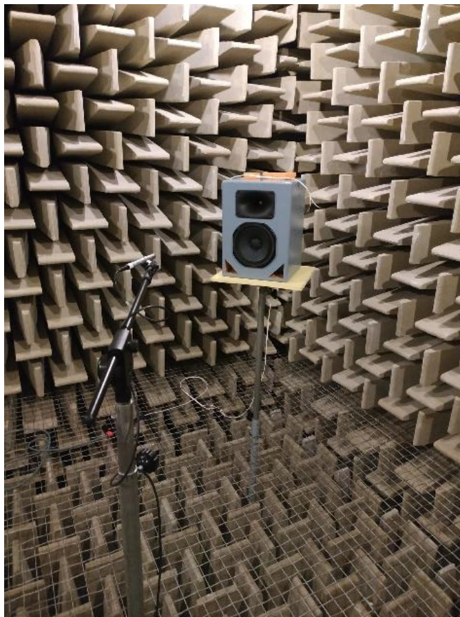
Obr. 22 Měření v bezodrazové komoře
