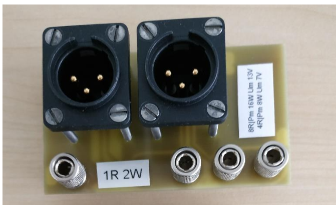
Obr. 12 Přípravek pro měření impedance reproduktoru
