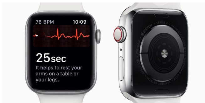
Obrázek 2.10.: Hodinky Apple Watch Series 4 s funkcí měření EKG, elektrody jsou na zadní straně hodinek [Převzato z [3]]
