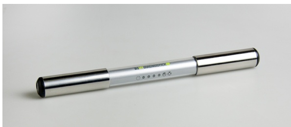
Obrázek 2.8.: Zařízení MyDiagnostick umožňuje měření EKG uchopením oběma rukama po dobu 1 minuty [Převzato z [1]]
