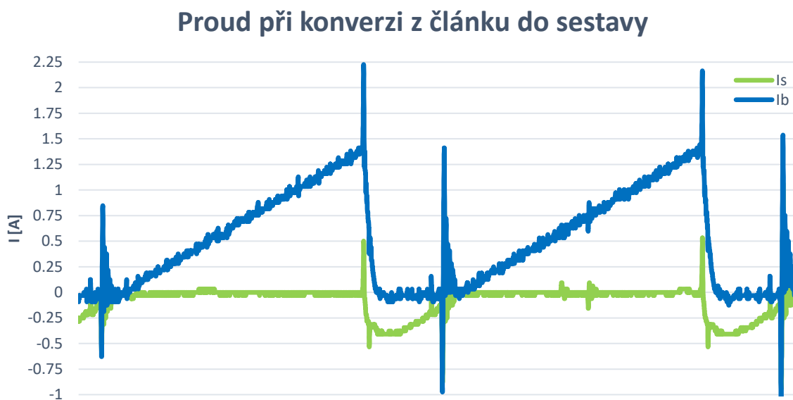
Obr. 5.3 Průběh proudu při konverzi z článku do sestavy (vybíjení článku)
