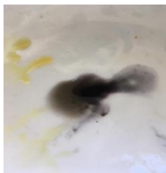
Obrázek 7 Provedená zcukřovací zkouška na vzorku sladiny před zcukřením
