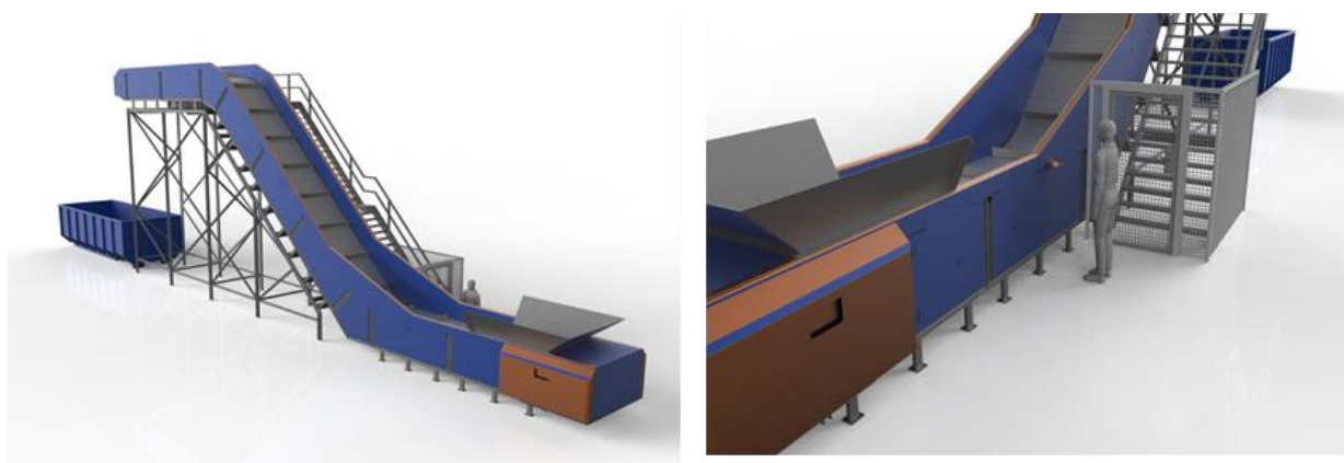
Obr. 6-3 Dopravník kusového odpadu v oblasti recyklace [Bezouška a kol., 2017]
