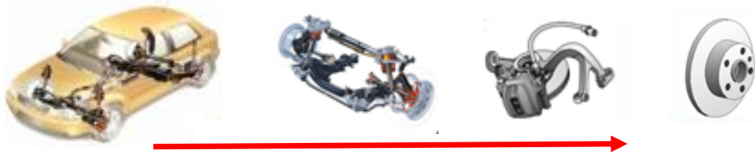
Obr. 3-10 Příklad hierarchického rozčlenění TS (automobil→přední náprava→brzdový systém→brzdový kotouč) [Machan 2012]
