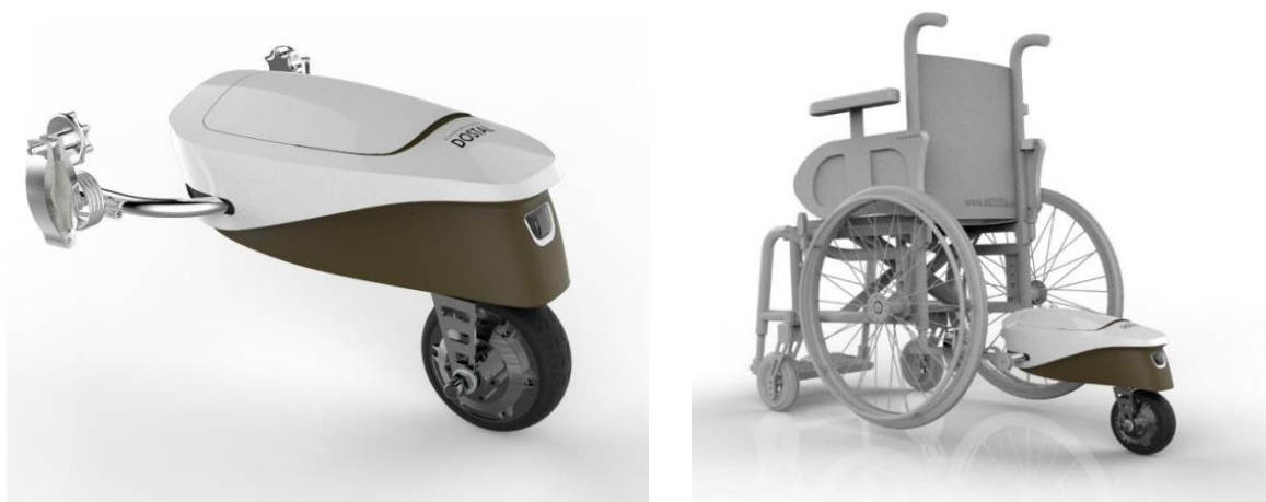
Obr. 6-2 Elektricky poháněné přídavné zařízení vozíků pro tělesně postižené [Štilip a kol., 2017]
