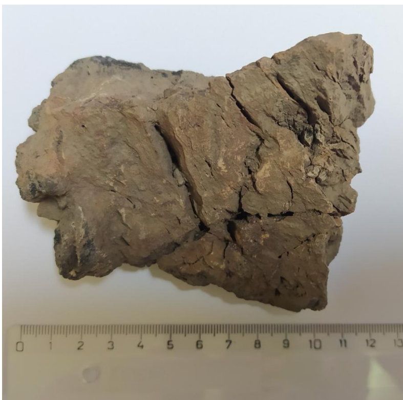
Obr. 44. Plzeň – Hradiště: analyzovaný vzorek č. 2 ze strany silně rozpraskaného a zčervenaleho metabazaltu (Dominik Vladař, 11. 5. 2020).
