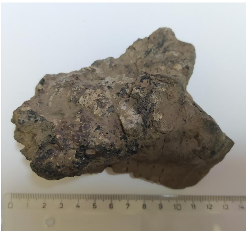
Obr. 45. Plzeň – Hradiště: analyzovaný vzorek č. 2 ze strany s pozůstatky zřetelné pórovitosti a lokálním výskytem sklovitého materiálu na povrchu (Dominik Vladař, 11. 5. 2020).
