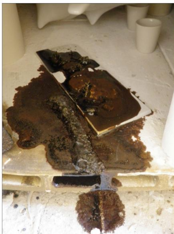
Obr. 9. Vnitřek keramické pece po zahřátí vzorku metabazaltu na 1300°C (Šmejda a kol. 2013, 176).
