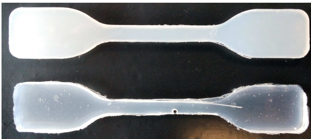
Obr. 27: Dobře a špatně odlitý 3 hm% SiO 2 vzorek dogbone
