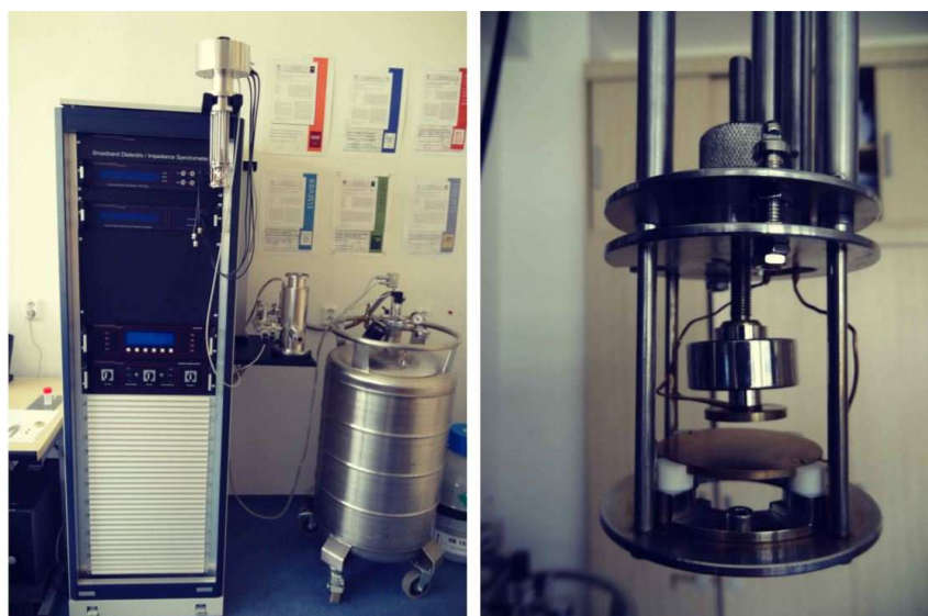
Obr. 35: Měření frekv. char. pomocí Novocontrol Alpha-A; převzato z [15]
