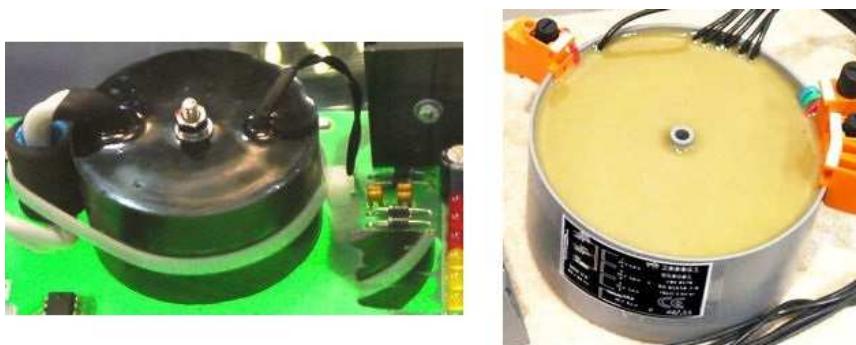
Obr. 14: Použití EP jako zalévací hmoty transformátorů; převzato z [26, 30]
