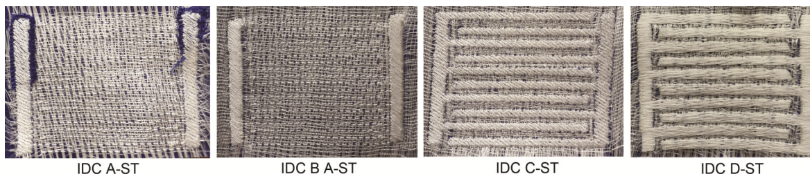
Obr. 2.8 Spodní strana (podšívka) vyšitých IDC s označením 3-ST.
