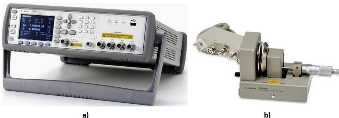
Obr. 3.1 a) LCR metr Agilent E4980A. [63]; b) Elektrodotý systém Agilent 16451B. [64]
