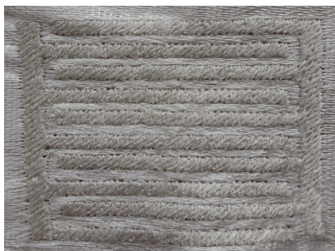
Obr. 2.9 Vyšitý IDC C na substrátu 2B, neboli IDC C-3ST.
