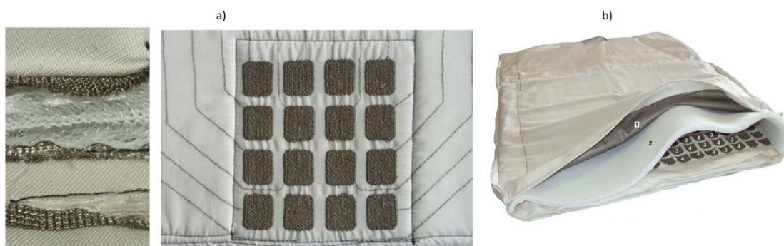
Obr. 1.18 a) Pole textilních kondenzátorů, b) senzor sezení. [55], [32]
