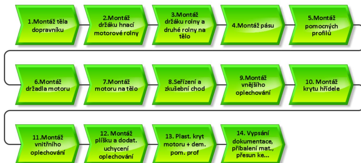
Obr. 17 Model procesu montáže s jednotlivými činnostmi
