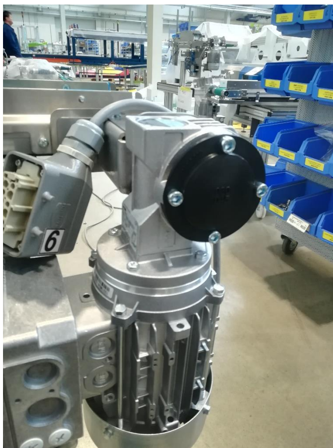
Obr. 20 Asynchronní motor připojen ke kabelu se speciální vidlicí
