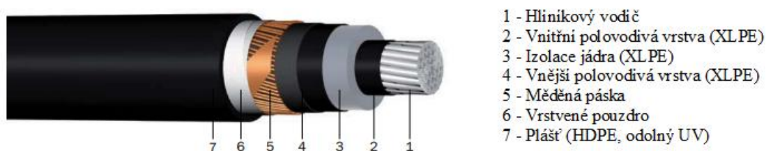
Obr.2: Kabel NA2XS(F)2Y (převzato s úpravami) [3]
