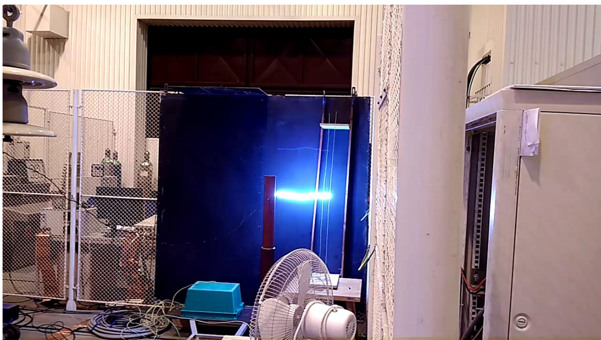
Obr. 27 Přeskok mezi elektrodou a vodičem
