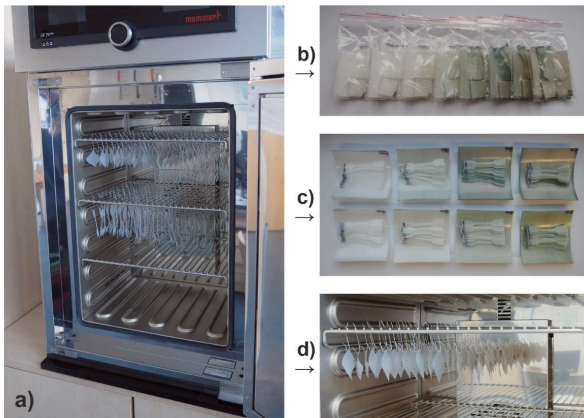
Obr. E.5: Fotodokumentace přípravy a umístění vzorků v horkovzdušné sušárně: a) horkovzdušná sušárna s částí testovaných vzorků, b) vzorky připravené v transportních obalech, c) vybrané vzorky před umístěním do sušárny, d) detail zavěšení vzorků s rozměry 3,5 × 3,5 cm.
