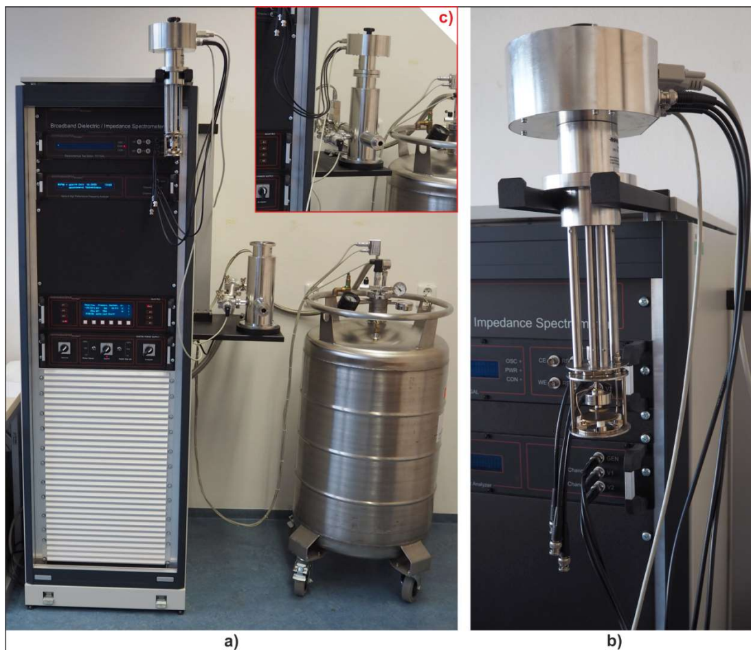
Obr. D.5: Širokopásmová dielektrická spektroskopie – aparatura se základní jednotkou Novocontrol Alpha-A: a) pohled na celou měřicí aparaturu, b) detail elektrodového systému zasunutého v kryostatu při měření, c) pohled na celý aktivní elektrodový systém.
