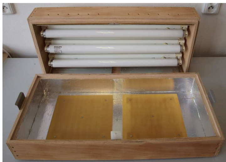
Obr. E.1: Otevřené zařízení pro expozici vzorků UV zářením (spodní díl s podložkami pro umístění vzorků a horní díl s UV zářivkami).
