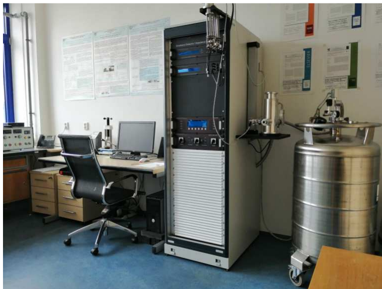
Obr. 1.3: Měřicí technika širokopásmové dielektrické spektroskopie, vpravo nádoba s kapalným dusíkem pro řízené ochlazování vzorku.
