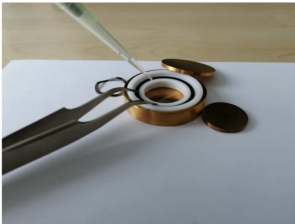
Obr. 4.6: Měřicí elektrody při nanášení vzorku oleje pro techniku širokopásmové dielektrické spektroskopie.
