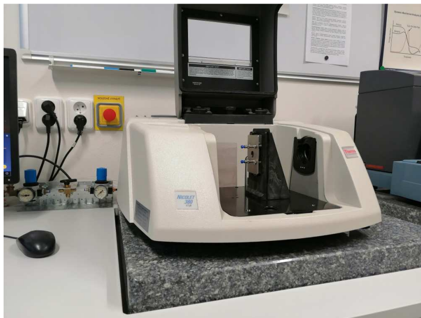
Obr. 1.2: Aparatura pro měření pomocí infračervené spektroskopie s Fourierovou transformací s připravenou kyvetou pro měření kapalných vzorků.
