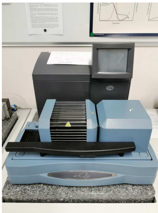
Obr. 1.5: Měřicí technika simultánní termická analýzy.
