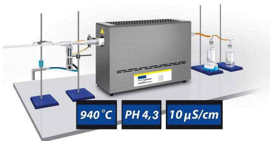
Obr. 1.5 Schéma aparatury pro stanovení doplňkové klasifikace kyselosti a vodivosti zplodin při hoření dle ČSN EN 60754-2, převzato z [23].
