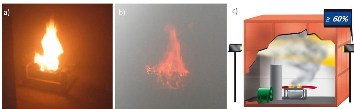
Obr. 1.4 Zkouška optické hustoty kouře dle ČSN EN 61034-2; a) vzorek kabelu vyhovující specifikaci s1b; b) vzorek kabelu produkující velké množství kouře; c) schéma testovací aparatury, převzato z [22], [23].
