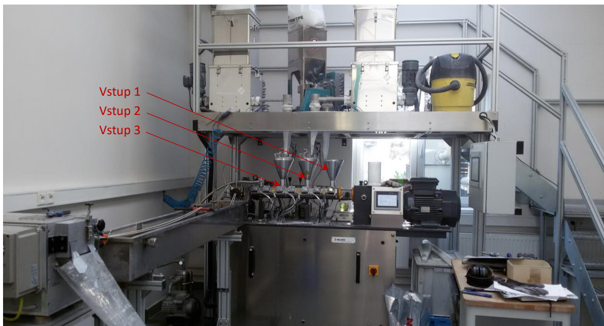
Obr. 10.1 Laboratorní kompaundační linka Buss MX 30.
