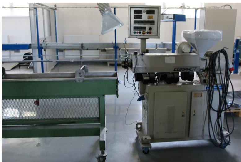
Obr. 9.2 Extruzní linka McNail Akron Compact typ 2148.
