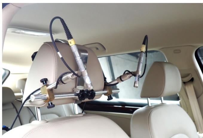
Obr. 5.4: Umístění měřicích mikrofonů v kabině automobilu.
