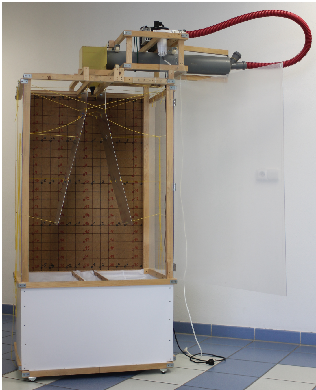
Obrázek 6.5: Pohled na celé experimentální zařízení jednostupňového free-fall elektrostatického separátoru
