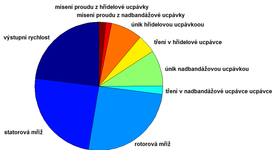
Obr. 16 Rozložení ztrát pro stupeň s reakcí 50% (ztrátový model DŠPW)
