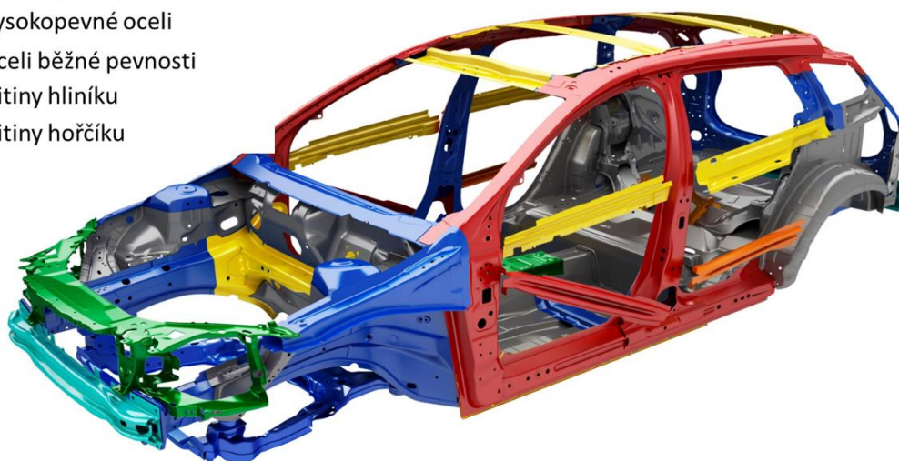
Obr. 5 Použití jednotlivých druhů ocelí a neželezných slitin při výrobě automobilové karoserie [5]
