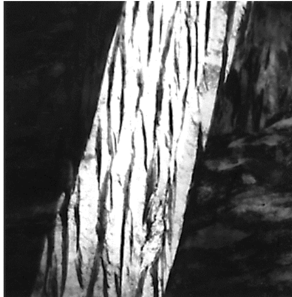
Obr. 24 Morfologie dolního bainitu – ocel s vyšším obsahem křemíku –TEM [101]
