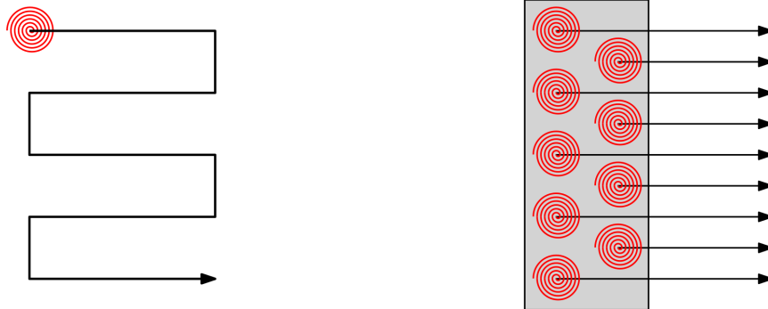
Obr. 3.20: Porovnání rastrování jednou sondou a použití pole cívkových sond
