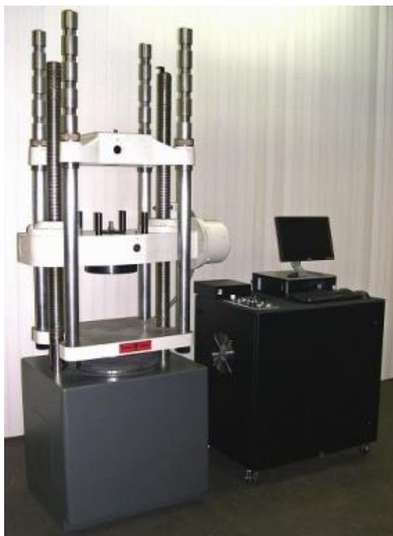
Obr. 9 Ilustrační fotka testovacího zařízení prodloužení Tinius-Olsen Super L. Převzato z [29].
