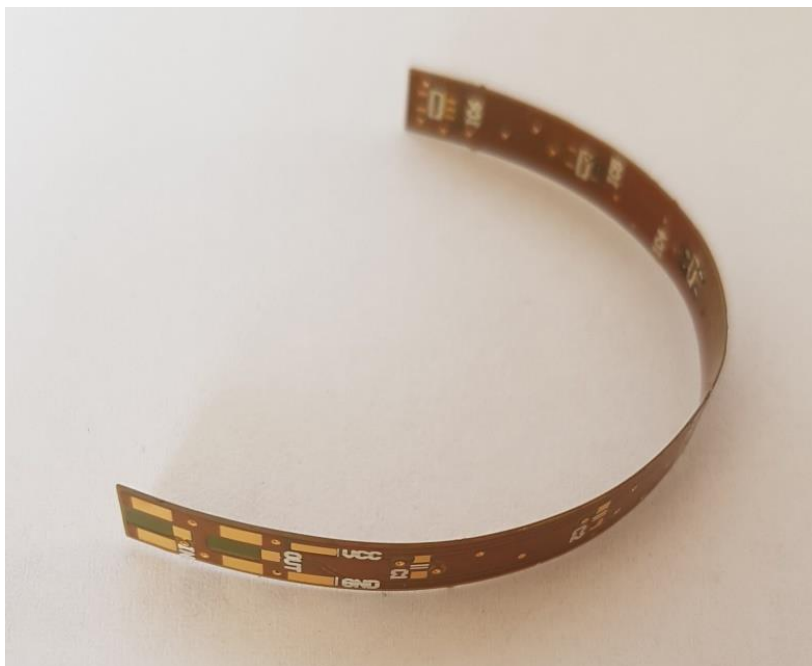
Obr. 20 Fotografie vzorku vyrobeného pro integraci do modelu lidské ruky v ohnuté poloze.
