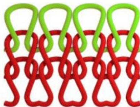
Obr. 20 Provázání vláken pleteniny (převzato z [41])
