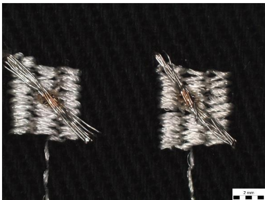
Obr. 41 Vytvořené vodivého místa odporovým svařováním
