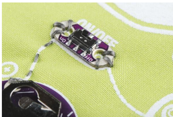
Obr. 30 Připojení DPS k textilii přešitím vodivou nití (převzato z [57])
