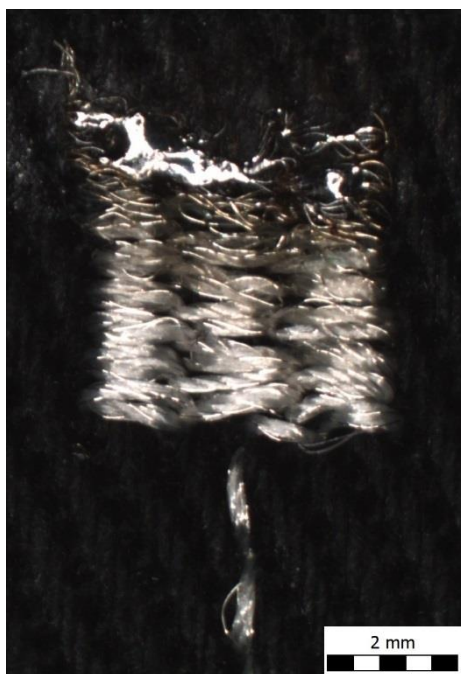
Obr. 43 Pájením vytvořený kontakt na plošce
