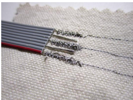
Obr. 29 Kontaktování přešitím (převzato z [58])
