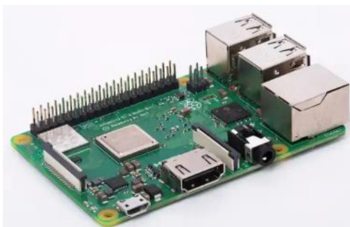
Obr. 4.5 Raspberry Pi 3 B+ (převzato z [43])
