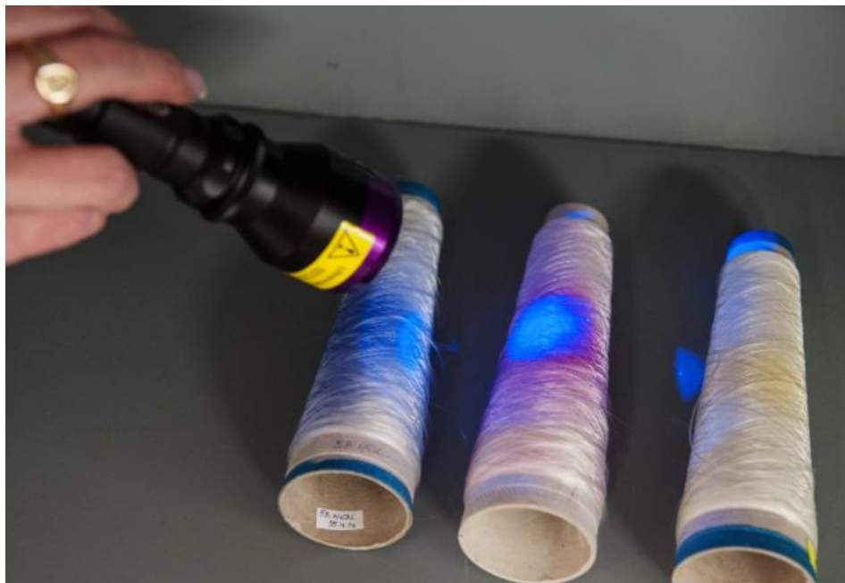
Obr. 1.5 Vlákna schopná měnit barvu díky UV záření (převzato z [7]).
