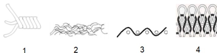
Obr. 1.7 Způsoby výroby tkanin. Tkaná příze se třemi svazky – 1; Střížová vlákna – 2; Znárodný řez tkaninou, která se skládá z osnovy s útkem pleteným nad a pod osnovními vlákny – 3; Pletená textílie – 4 (převzato z [12]).
