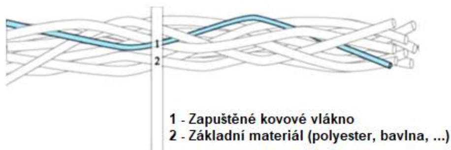
Obr. 3.3 Schematické znázornění kombinace vodivého vlákna -1 s konvenčním vláknem -2 (např. bavlna, polyester) (převzato z [9]).
