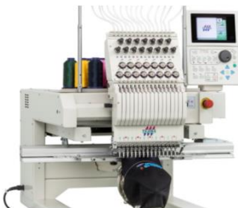
Obr. 3.10 Příklad průmyslového vyšívacího stroje (převzato z [26]).
