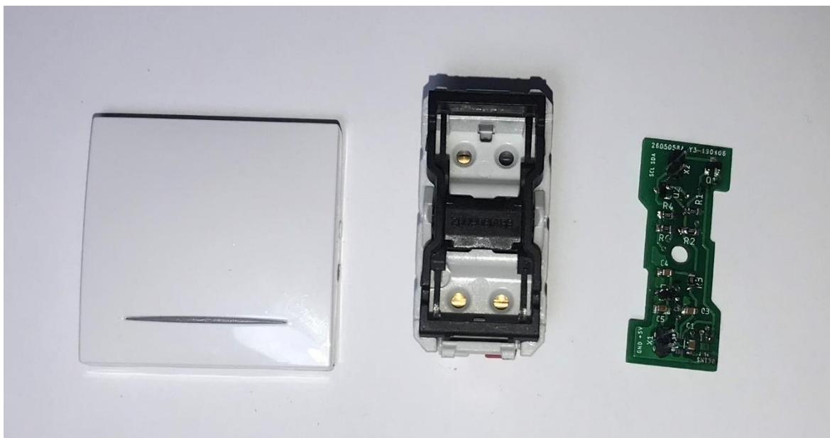
Obr.2.11: Sensorová deska spolu s rozebraným vypínačem, kde bude umístěna
