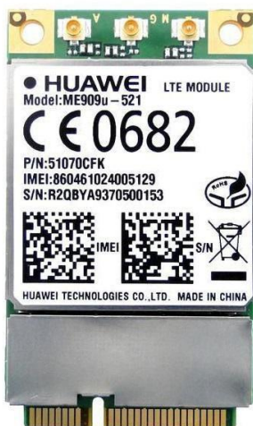
Obrázek 11 LTE modem Huawei ME909u-521 mPCI Express [13]
