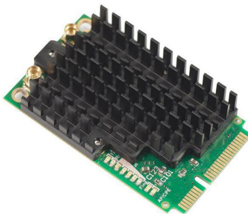
Obrázek 12 MIKROTIK R11e-2HPnD miniPCI-e karta 802.11b/g/n [14]
