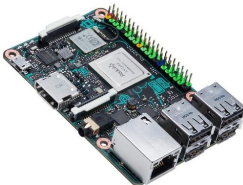
Obrázek 9 Jednodeskový počítač ASUS Tinker Board S [11]
