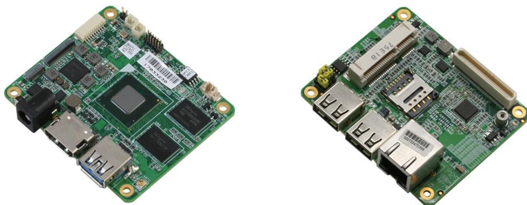
Obrázek 7 Jednodeskový počítač UP Core [9]
