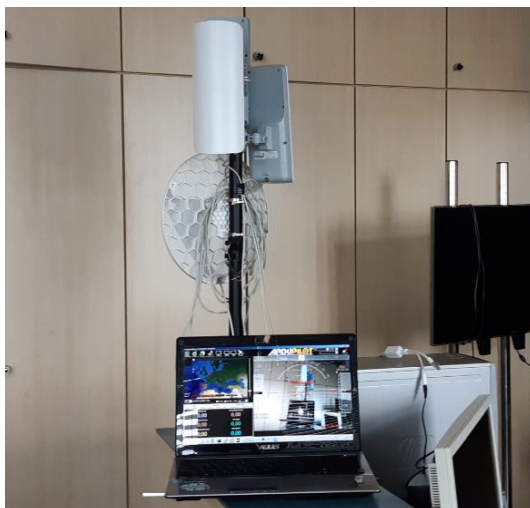
Obrázek 15 Kompletní konfigurace pozemní stanice
