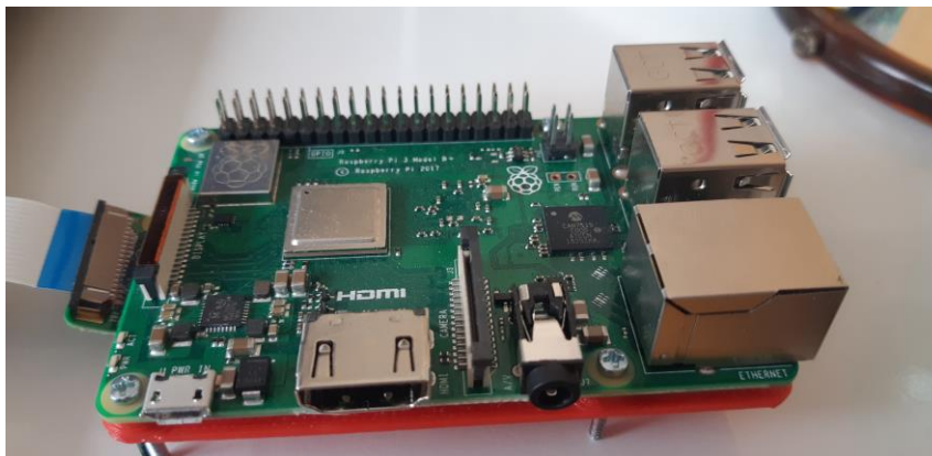
Obrázek 4 Jednodeskový počítač Raspberry Pi 3B+
