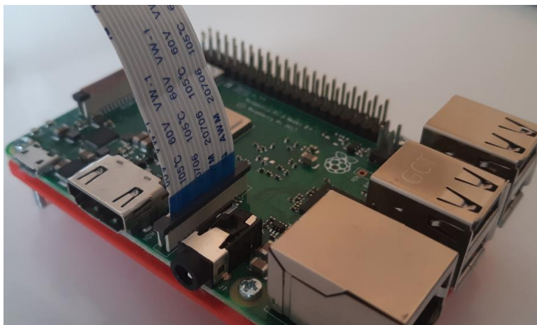
Obrázek 22 Zapojený modul kamery do CSI portu
