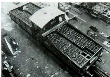
Obr.3 bateriová lokomotiva Škoda E417 (1931)
