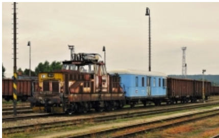
Obr.4 elektrická posunovací lokomotiva s bateriovým vozem
