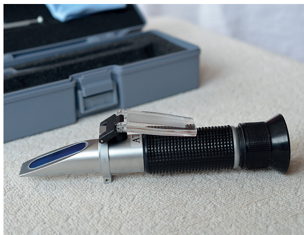
Obr. 1. Refraktometr pro ovocné šťávy a slané nálevy RBS2 – ATC (foto autoři).
