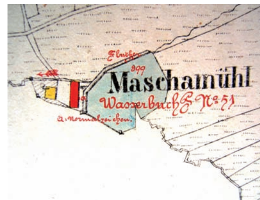
4) Výřez vodopisné mapy vytvořené na podkladě stabilního katastru jako součást dokumentace vodního díla k vodním knihám na sklonku 19. století. Stavba se zařizuje na vodní pohon je vždy zvýrazněna červenou barvou, tak jako poloha cejchu a jiné relevantní informace (cejch na výřezu mapy označen písmenem „a“). Lokalita Mášův mlýn (vlevo). Fotografie polohy cejchu v terénu (bílá šipka) a jeho detailní vzhled (vpravo) (foto: L. Galusová 2009). Ausschnitt der auf Grundlage des Stablen Katasters erstellten hydrographischen Landkarte als Bestandteil der Dokumentation eines Wasserwerks am Ende des 19. Jahrhunderts. Der Bau mit der Wasserantriebsanlage ist durchgängig mit roter Farbe markiert, genauso wie die Position des Eichzeichens und weitere relevante Informationen (Kennzeichnung des Eichzeichens auf dem Ausschnitt mit dem Buchstaben „a“). Die Lokalität der Máša-Mühle (links). Fotografie der Lage des Eichzeichens im Terrain (weißer Pfeil) und sein detailliertes Aussehen (rechts) (Foto: L. Galusová 2009).
