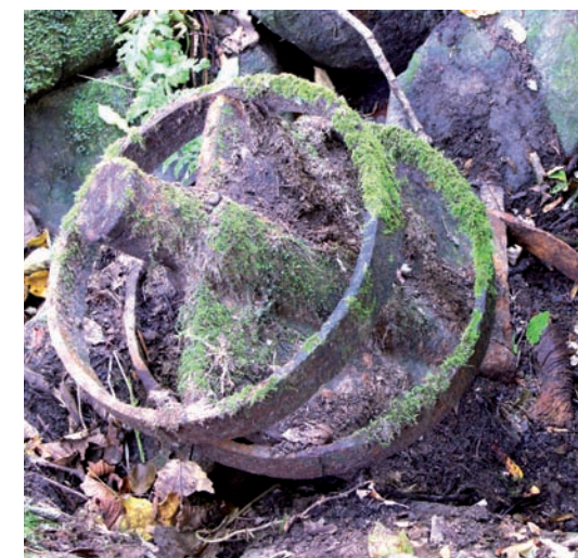
6) Mášův mlýn (okres Tachov). Kovové relikty zařízení: Lopatovitý čep hřídele vodního kola se třemi zděření (objímkami hřídele) v takřka původní poloze v lednici u otvoru pro hřídel vodního kola (foto: J. Anderle 2007). Máša-Mühle (Kreis Tachau). Metallrelikte der Ausstattung: Schaufelbolzen des Wasserrades mit drei Ringen (Wellenführung) in der fast ursprünglichen Lage in der Kühlkammer an der Öffnung für die Welle des Wasserrades (Foto: J. Anderle 2007).
