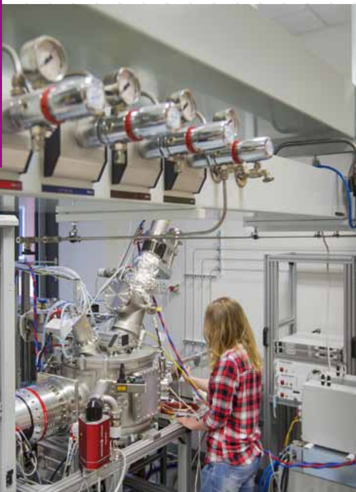
Vakuová komora pro přípravu tenkovrstvých materiálů.
