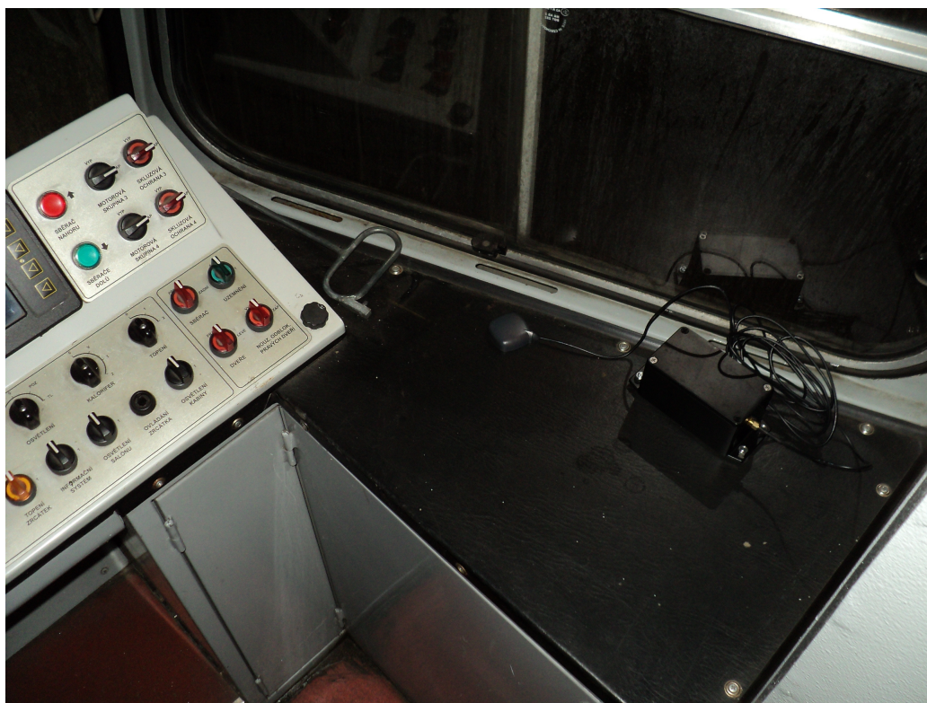
Obr. 6.4: Fotografie měřicího zařízení nainstalovaného v tramvaji
