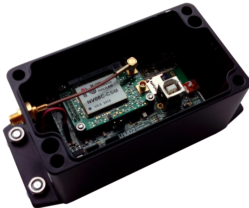
Obr. 4.7: Fotografie navrženého zařízení pro měření a sběr dat
