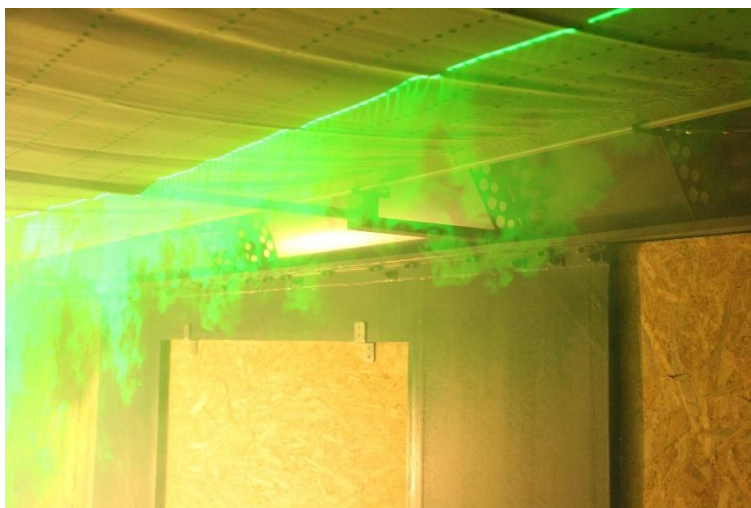
Obr. 214 Průběh zkoušky planárním laserem – varianta perforace
