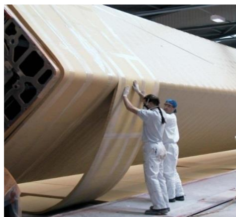
Obr. 10 Navíjení skříně Variel [29]
