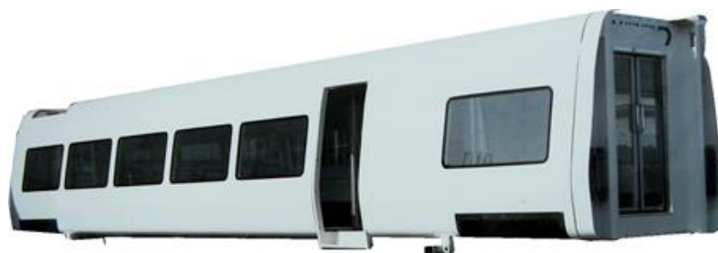
Obr. 9 Finální stavba skříně vyráběné technologií navíjení [19]
