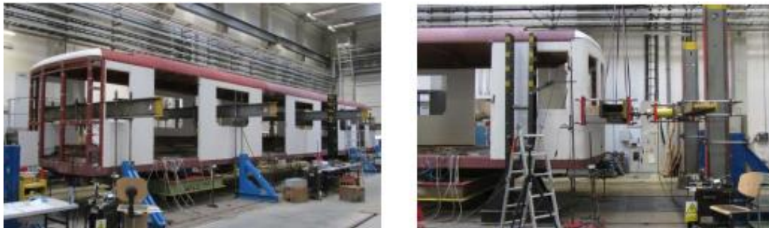
Obr. 28 Statické pevnostní zkoušky skříně, vlevo zkouška tlakem na čelnici pod úrovní dolní hrany oken
