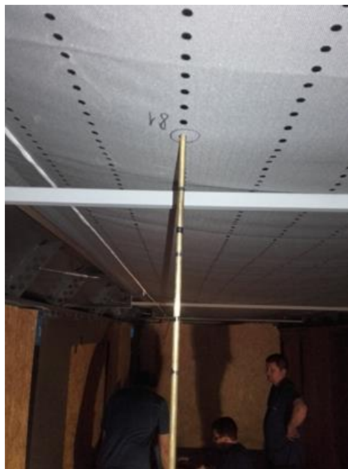
Obr. 95 Vyobrazení zasunutí Prandtlvy sondy do kanálu skrze otvory ve tkaninovém potrubí v bodě 81
