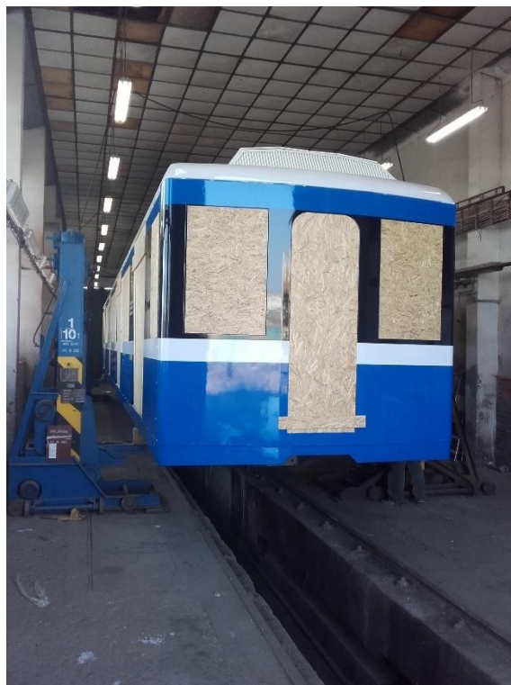
Obr. 209 Příprava vozu pro měření provětratelnosti – zaslepení okenních a dveřních otvorů
