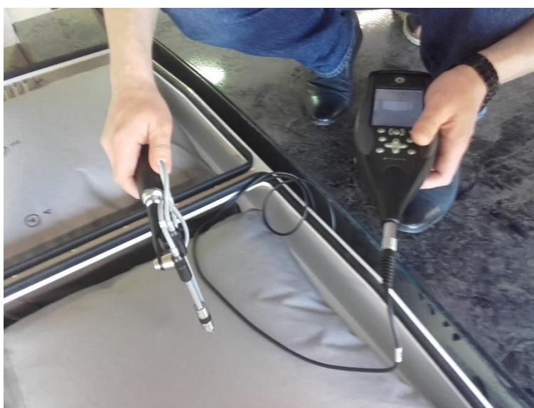
Obr. 215 Zkouška hlučnosti v oblasti lomeného kanálu větrací jednotky
