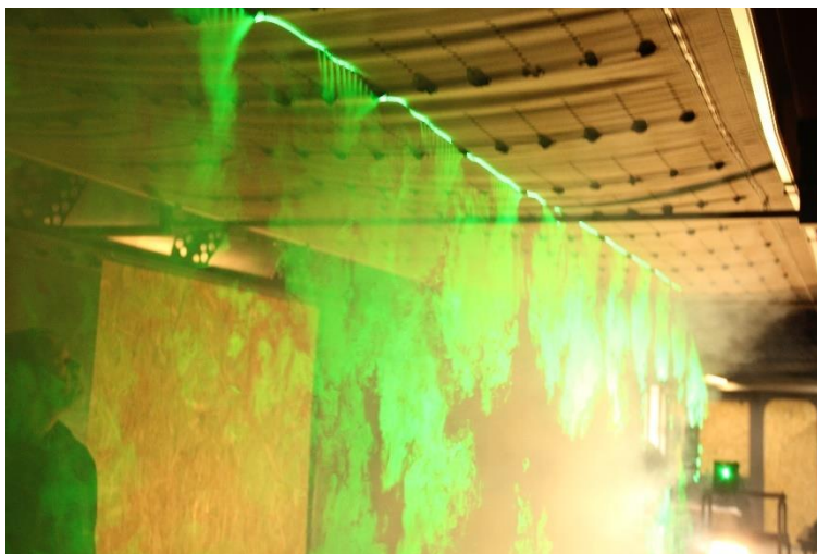
Obr. 213 Průběh zkoušky planárním laserem – varianta perforace + usměrňující kapsy
