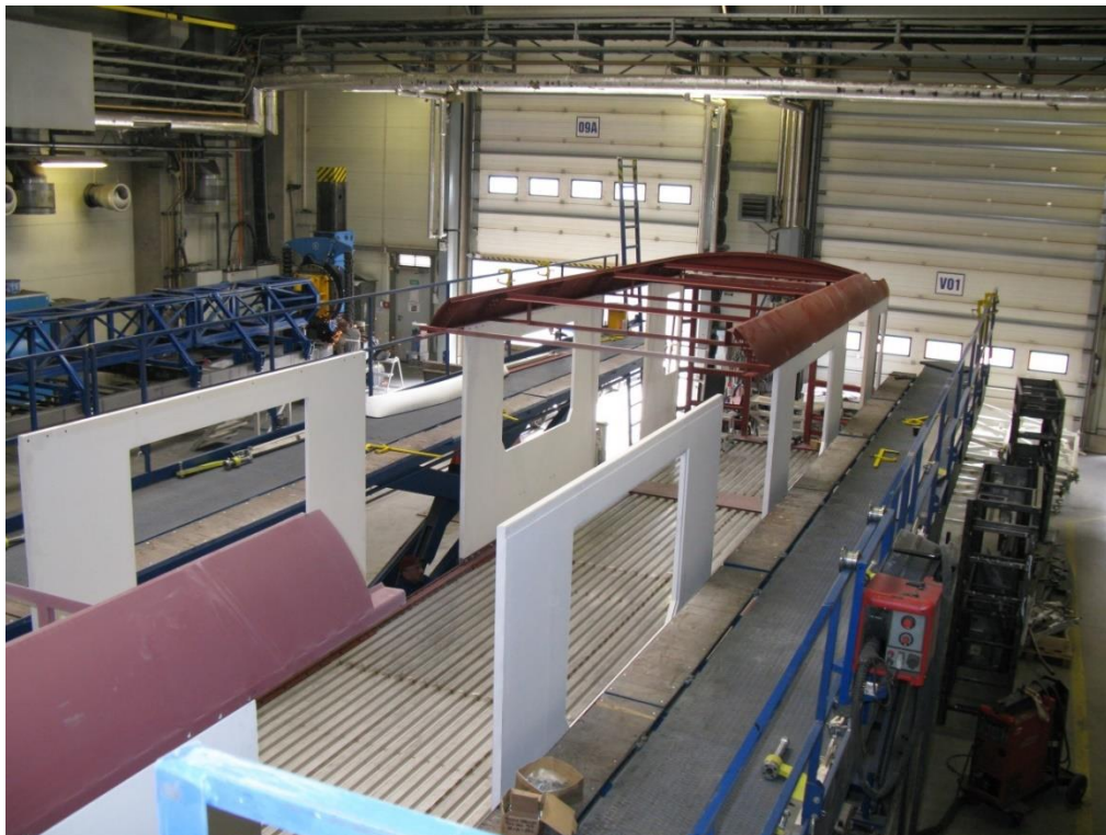
Obr. 206 Průběh montáže střechy vozu metra
