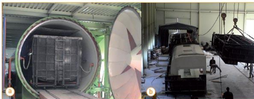
Obr. 11 Proces vytvrzování vozu Korea Railroad Research Institute (KRRI) v autoklávu [30]
