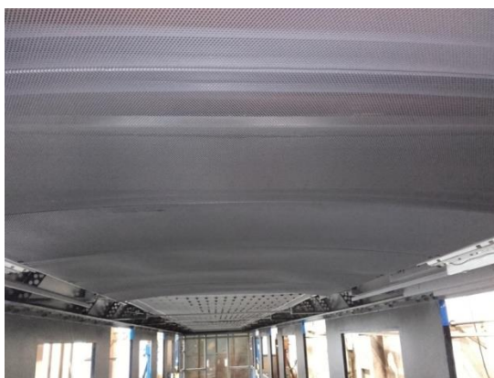
Obr. 145 Pohled do funkčního vzorku vozidla metra s ukázkou podhledového panelu – krytí textilního kanálu
