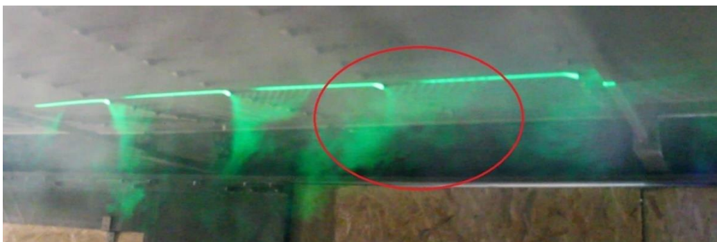
Obr. 122 Zvýrazněné proudnice pro výkon 100 % - varianta s kapsičkami (červeně vyznačený svazek proudů s patrnou nedostatečnou funkcí kapsičky)
