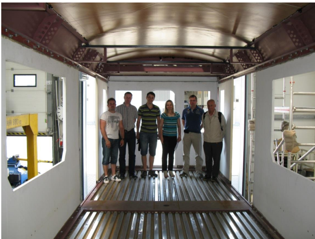
Obr. 204 Pohled do hrubé stavby skříň vozu
