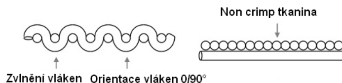
Obr. 13 Multiaxiální tkanina s orientací vrstev 0/90 [8]
