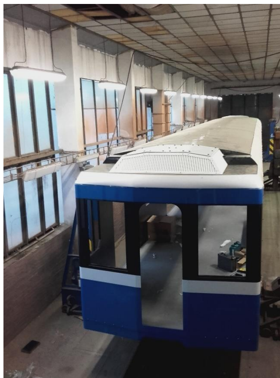
Obr. 207 Pohled na funkční vzorek hrubé stavby hybridní skříně s osazenými větracími jednotkami
