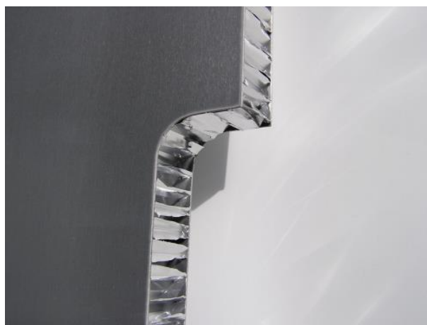
Obr. 17 Řez celohliníkovým sendvičem s voštinovým jádrem [28]
