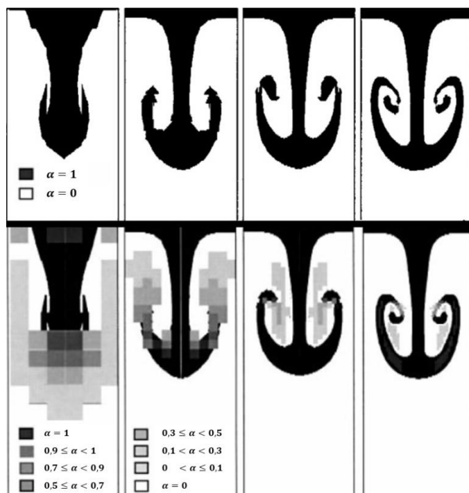
Obr. 7: Rozvoj tvaru Rayleighovy – Taylorovy nestability v tíhovém poli z klidného rozhraní vzduchu (dole, \alpha = 0 ) a vody (nahore, \alpha = 1 ), převzato z [22]. Nahore tvar rozhraní určený pomocí VOF, dole rozložení objemového podílu vody vypočtené pomocí dvoutekutinového modelu. Počet buněk zleva: 6 \times 30 , 12 \times 60 , 24 \times 120 a 48 \times 240 .
