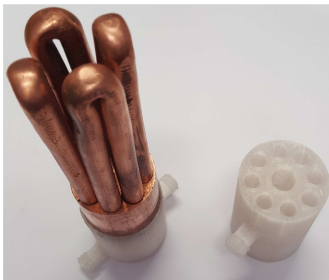
Obr. 6.1.2 Reálný výrobek studeného kelímku s vrtaným dnem a 3D tištěným kolektorem
