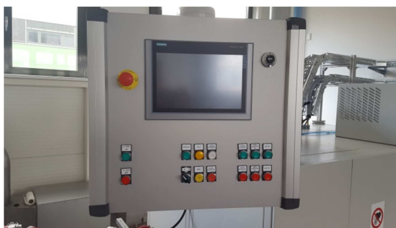
Obr. 2.2.4 Uživatelské rozhraní HFG160 – Siemens Simatic
