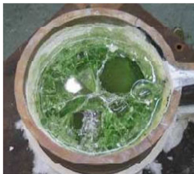
Obr. 2.4.3 Zkrystalizované sklo po použití plynového hořáku jako startovací fáze [22]
