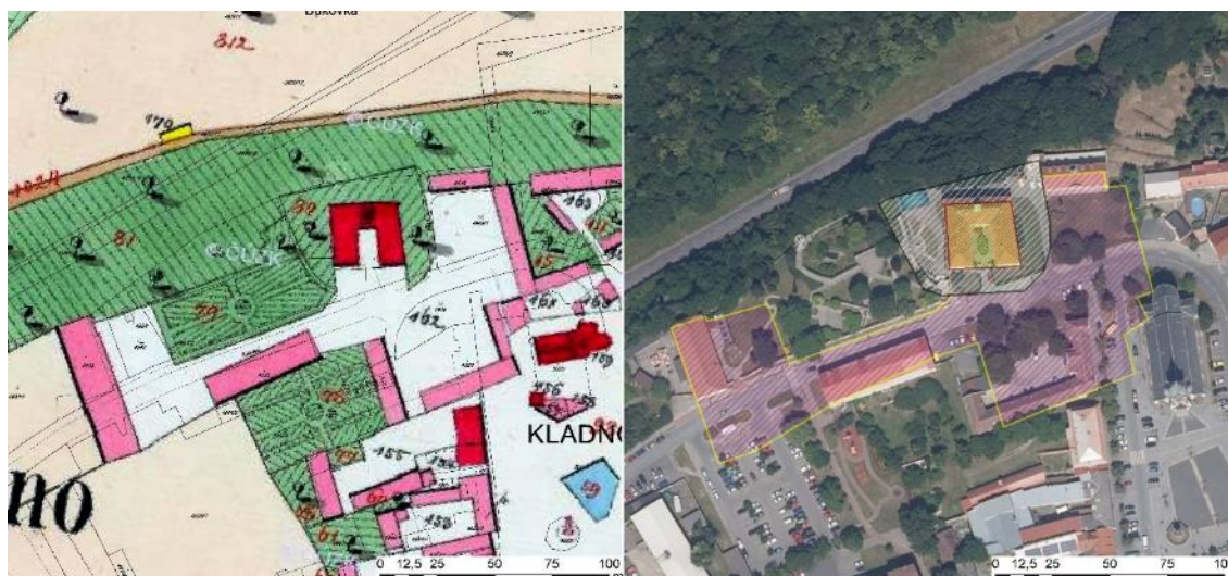
Obr. 13. Příklad prostorového vymezení sídla na základě katastrálních map. Vlevo – podkladová data; vpravo – výsledné vymezení na aktuálním ortosnímku (žlutá šrafura – jádro; bílá šrafura – celkový rozsah; fialová šrafura – dvůr). Zpracoval D. Novák. Podkladová data ČÚZK.
