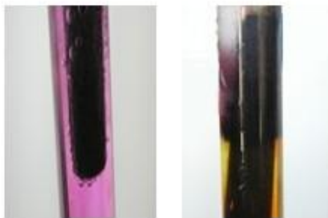
foto: Vznikající vodík a pozitivní reakce fenolftaleinu s hydroxidem draselným (vlevo), vznikající jod se škrobovým mazem (vpravo)
