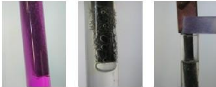
foto: Průběh pokusu se vznikajícím vodíkem a pozitivní reakcí fenolftaleinu (vlevo), vznikajícím chlorem (uprostřed) a pozitivní reakcí jodidoškrobového papírku (vpravo)
