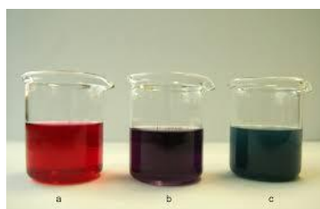
Obr. č. 28 Změna barvy antokyanů z červeného zelí v závislosti na pH: a) po přidání octu, b) původní roztok červeného zelí, c) po přidání roztoku mýdla [31]
