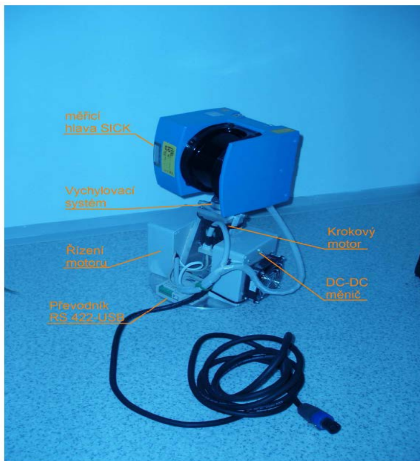
Obr. 29: Dálkový pozemní skener od O. Pilíka (autor: O. Pilík).
