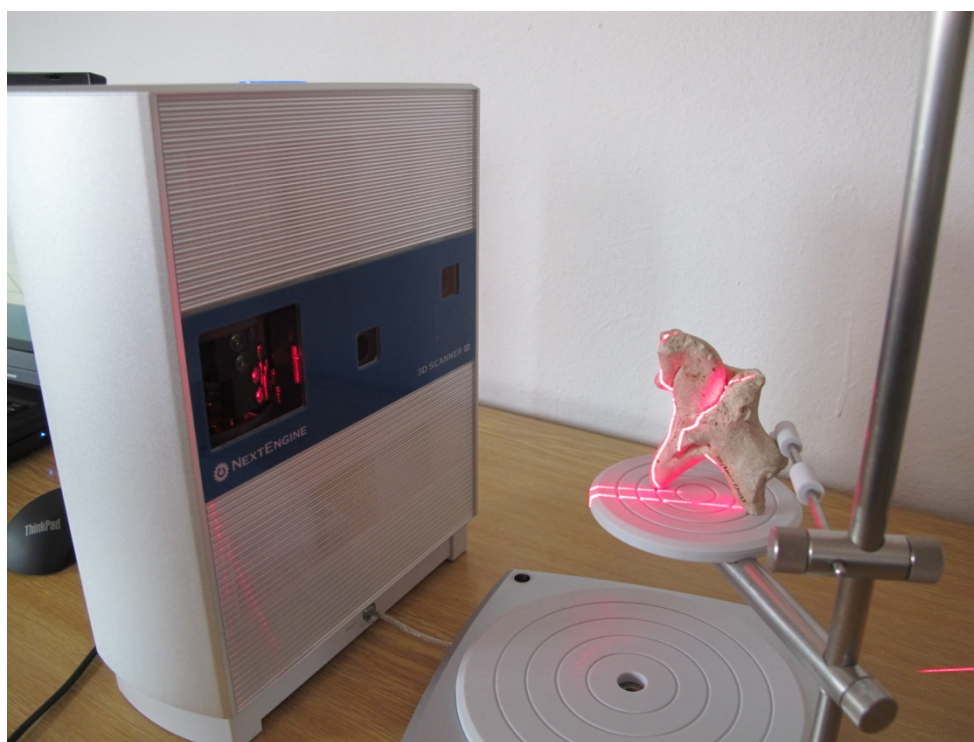
Obr. 31: Skener NextEngine HD při záznamu textury horní obrázek a při průběhu skenování dolní obrázek.
