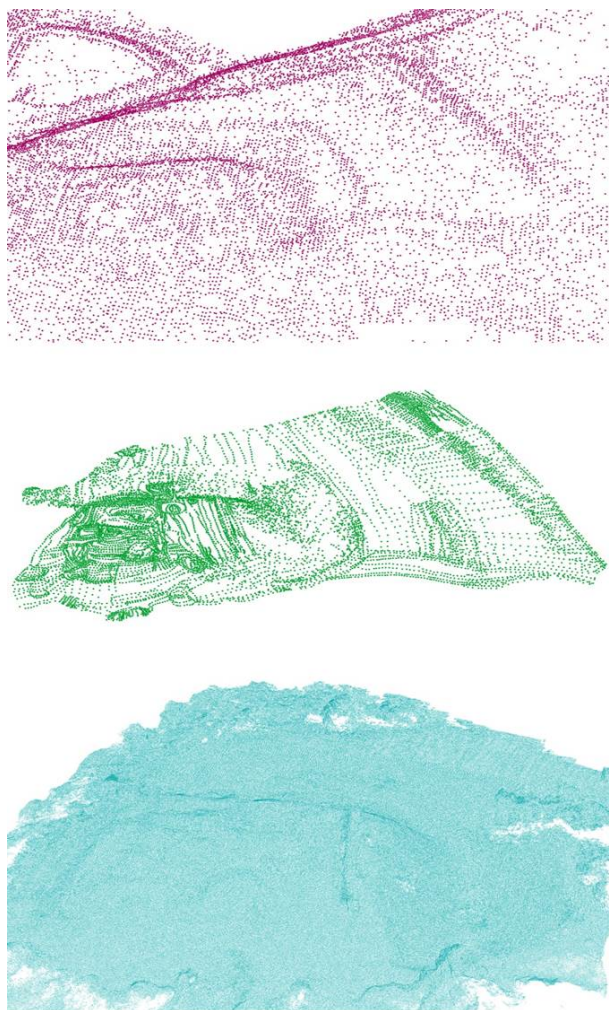
Obr. 113: Mračna bodů v jednotlivých typech dat (nahore: DMR 5G, uprostřed: měření totální stanicí, dole: letecká RPAS fotogrammetrie).
