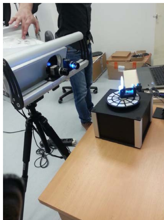
Obr. 73 Technické parametry optického skeneru RangeVision (vlevo) a skenování povrchu mince Habsburské soustátí (vpravo).
