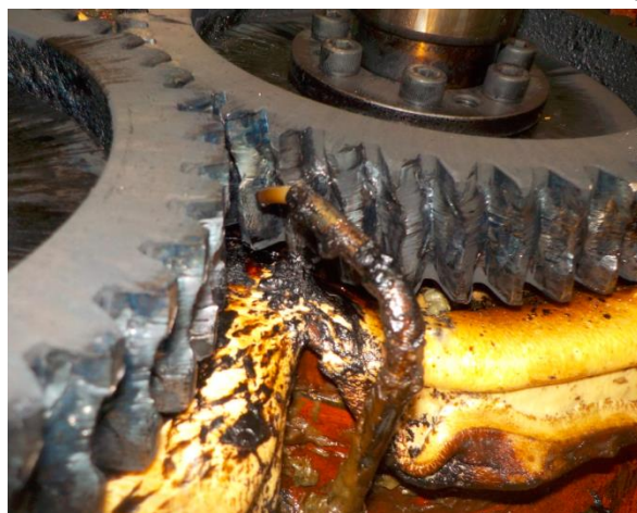
Obr.103 Namontovaný plastový kryt (vlevo); plastový kryt deformovaný v průběhu provozu (vpravo)
