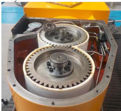
Obr.103 Namontovaný plastový kryt (vlevo); plastový kryt deformovaný v průběhu provozu (vpravo)
