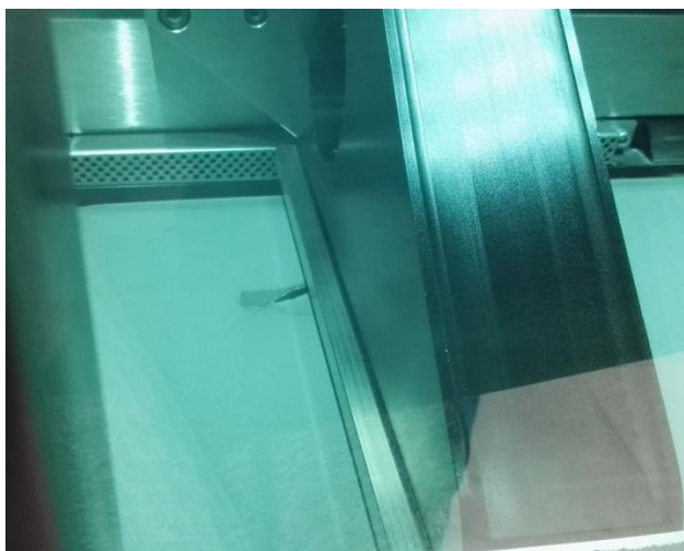
Obr.44 Zvednutí dílu způsobené vlivem pnutí
