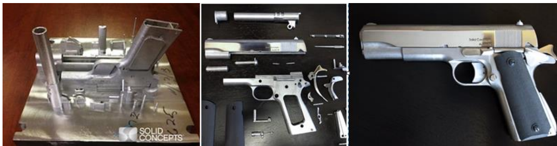
Obr.9 Poloautomatická pistole M1911 vyrobená technologií DMLS [44], [47]
