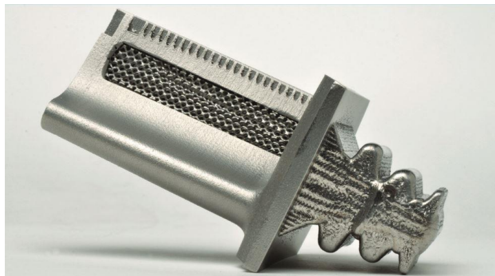
Obr.3 Lopatka vyrobená technologií SLM [32]
