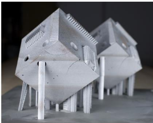
Obr.43 Ukázka trhlin na součásti způsobených vnitřním pnutím
