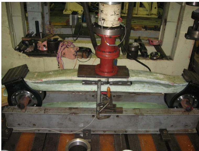
Foto 10-5 Podélník #8 při statickém zatížení F = 250 kN
