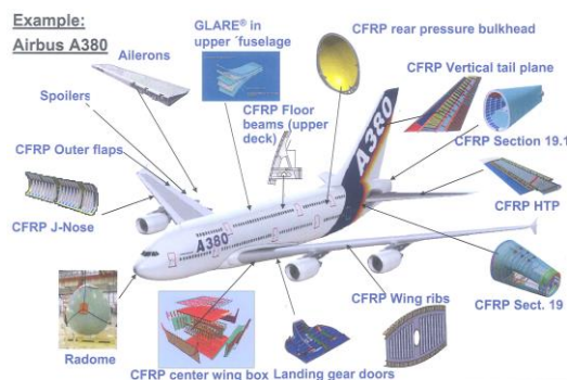
Foto 3-6 Dopravní letadlo Airbus A380 a podíl kompozitů na jeho konstrukci
