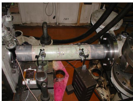
Foto 3-13 Dutý kompozitní GFRP hřídel – průběh zatížení
