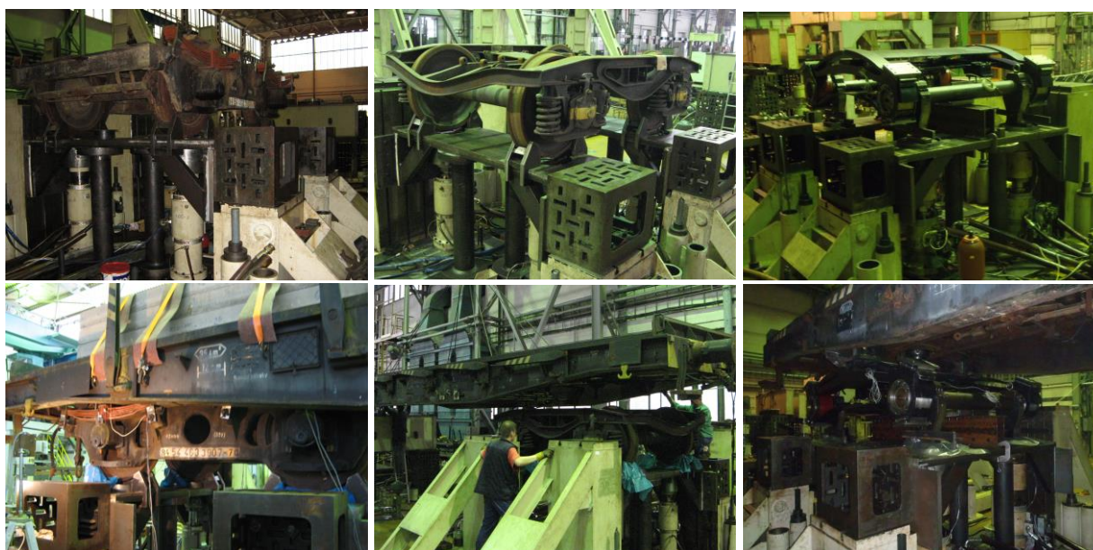
Foto 12-1 Speciální zkušební stand pro výzkum dynamických vlastností
