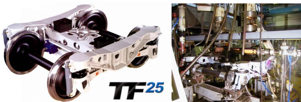
Foto 3-14 „Track friendly“ podvozek a jeho testování
