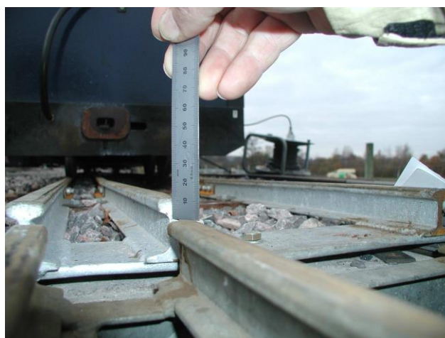
Foto 9-6 Rozdílná výška kolejnic při drop testu
