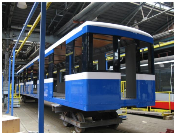
Foto 3-12 Hybridní skříň vozidla metra – složení, zdroj: [projekt MPO TIP: FR-TI3/449]
