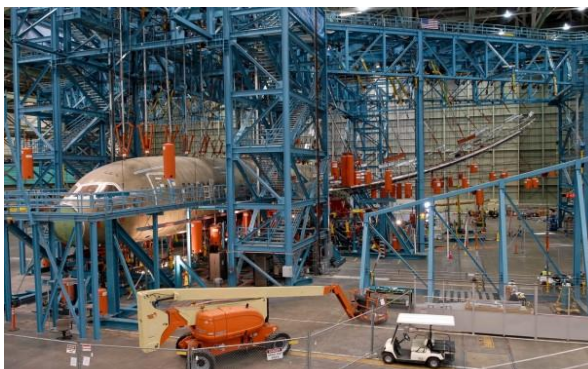
Foto 3-9 Dopravní letadlo Boeing 787 Dreamliner při výrobě a pevnostních testech
