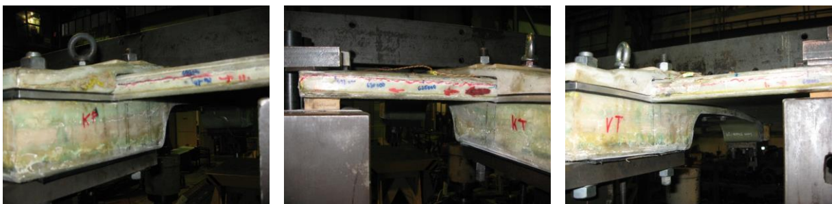
Foto 11-7 Delaminace příčnicku při únavové zkoušce
