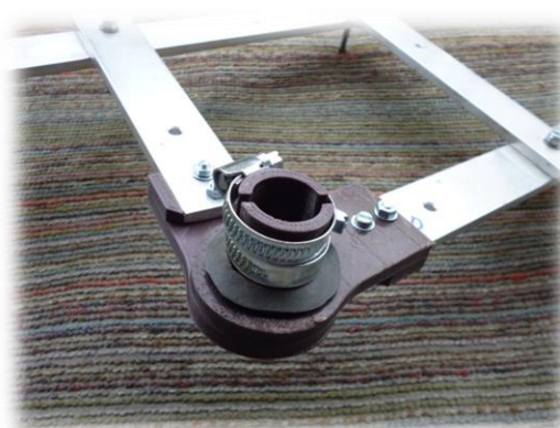
Obrázek 6 - detail držáku frézky
