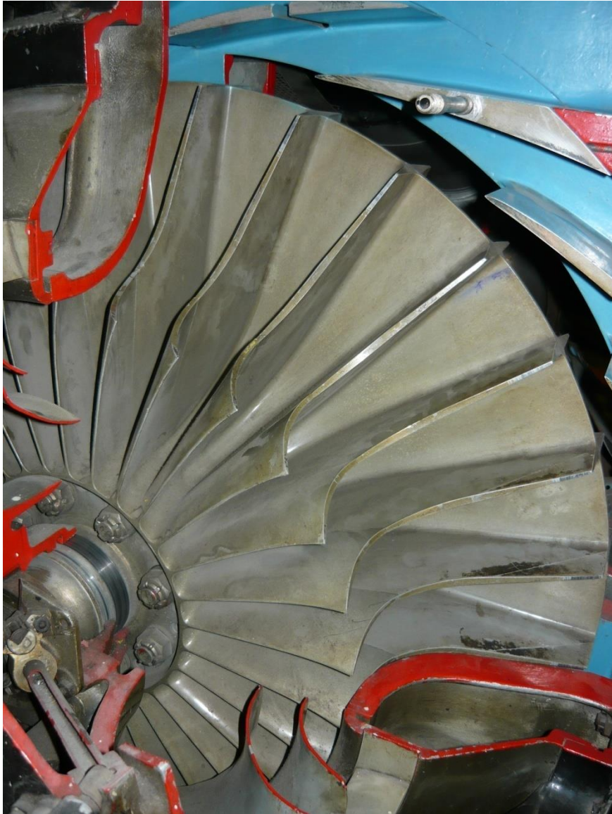
Obr. 26 Oboustranné oběžné kolo odstředivého kompresoru jednoproudového leteckého turbokompresorového motoru VK-1
