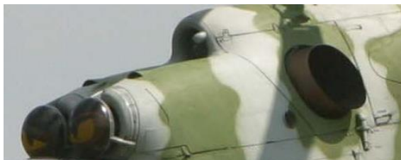
Obr. 2.6 Protiprachové zařízení na vstupu do vrtulníkového ThLTKM TV3-117
