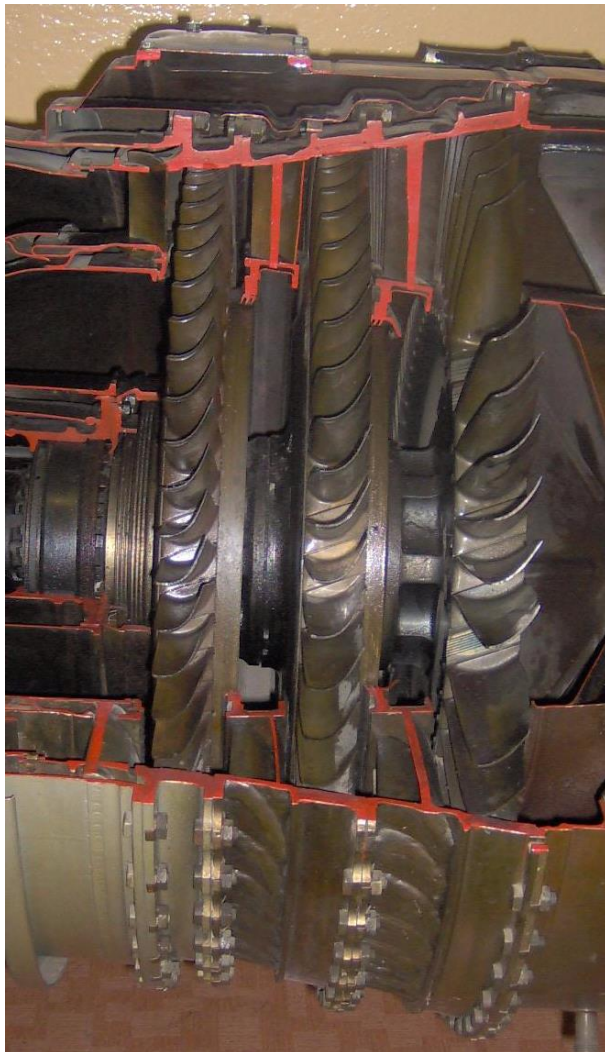
Obr. 6.7 Třístupňová jednohřídelová plynová turbína motoru AI-20M
