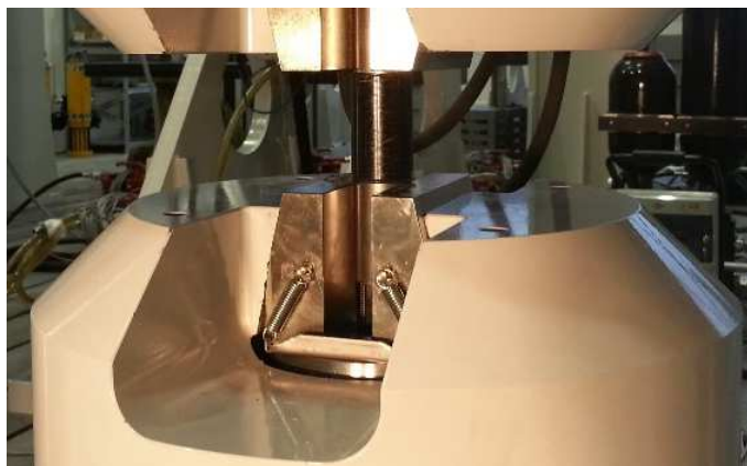
Obr. 83 - Zatěžování vzorku lepeného spoje na zkušebním stroji
