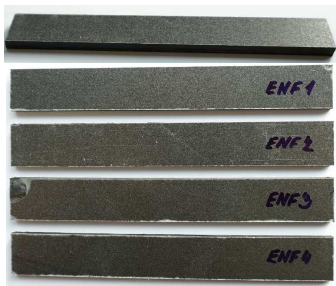
Obr. 75 - Vzorky určené pro ENF test
