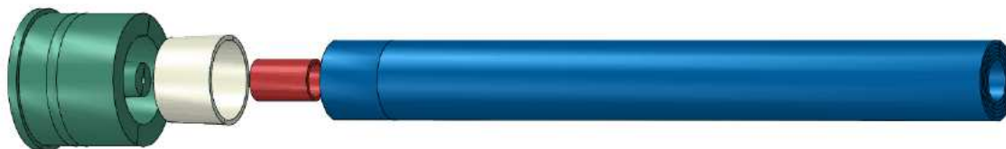
Obr. 58 - Model pro výpočet lepeného spoje pomocí MKP [43]
