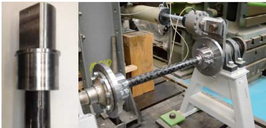
Obr. 57 - Tvar vzorku a způsob jeho upnutí na zkušebním stroji [43]
