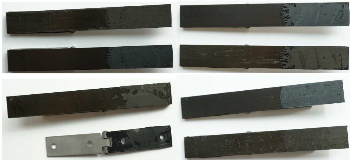
Obr. 71 - DCB vzorky 1, 2, 4, 6 po porušení
