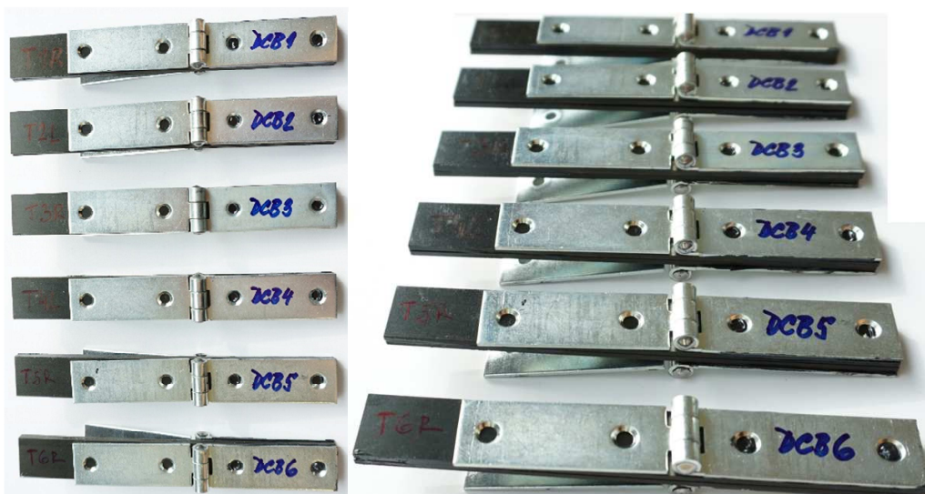
Obr. 69 - Vzorky určené pro DCB test
