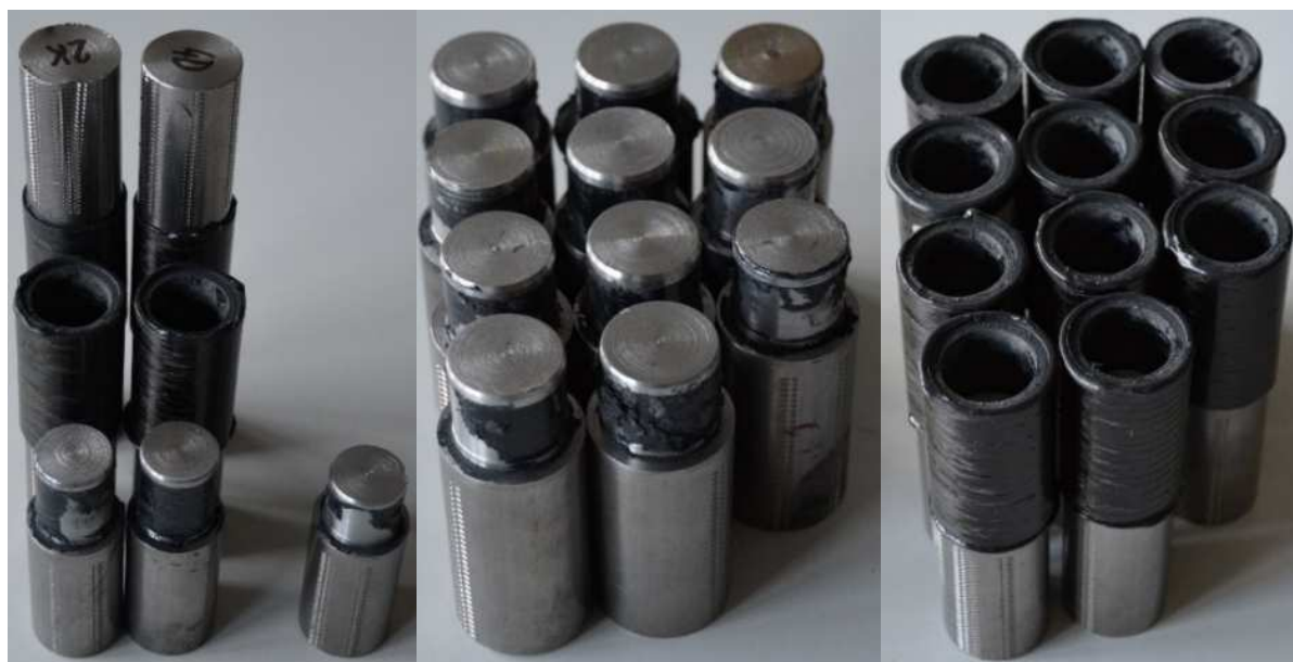
Obr. 85 - Vzorky vyřazené a vzorky s vhodným mechanismem porušení
