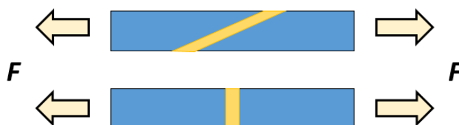
Obr. 11 - Překládaný spoj tupý (dole) a spoj s úkosem (nahore)
