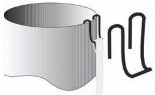
Obr. 1 – drátěný závěs ze sponky k zavěšení staniolového pásku
