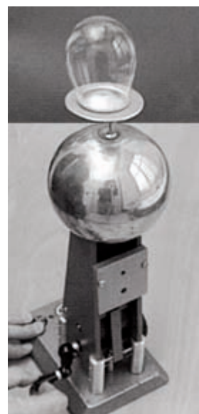
Obr. 8 – silové působení na nabitou bublinu
