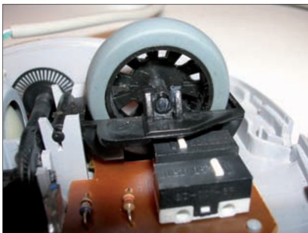
Obr. 7 – Část myši s vloženým kolečkem
