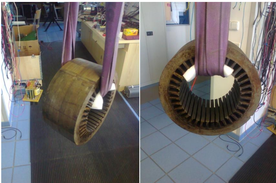
Obr. 5.5: Magnetické jádro statoru při měření modální analýzy
