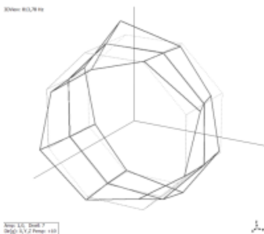
Obr. 5.6: Vlastní tvar 2,1; frekvence 813 Hz
