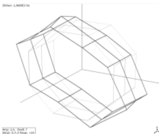
Obr. 5.7: Vlastní tvar 2,0; frekvence 1070 Hz
