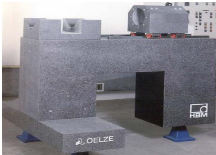
Obr. 3.4.: Rám stroje z granitu[Oelze2010]
