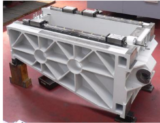
Obr. 3.2: Svařovaný a odlitý rám[SpOS 2002]
