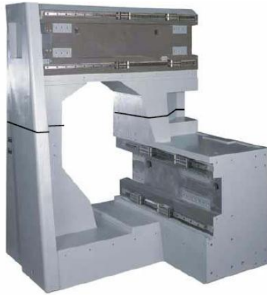
Obr. 3.3.: Rám stroje z minerální litiny[Framag 2010]
