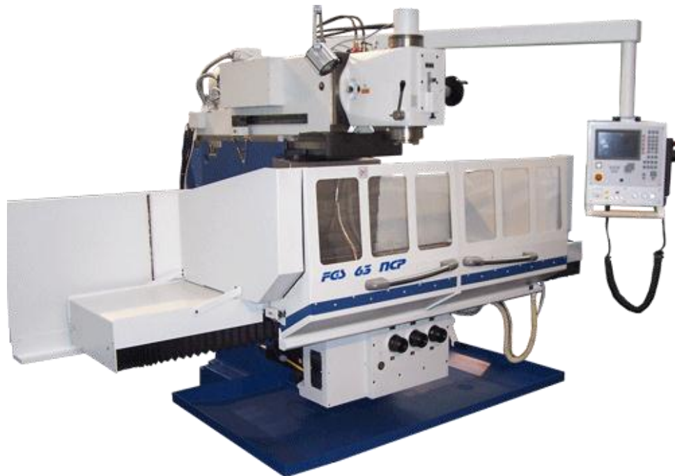
Obr. 4.46 Moderní konzolová frézka ( výrobce Strojtos Lipník) – na vřeteníku je připevněno přídavné frézovací zařízení. [Strojtos2010]
