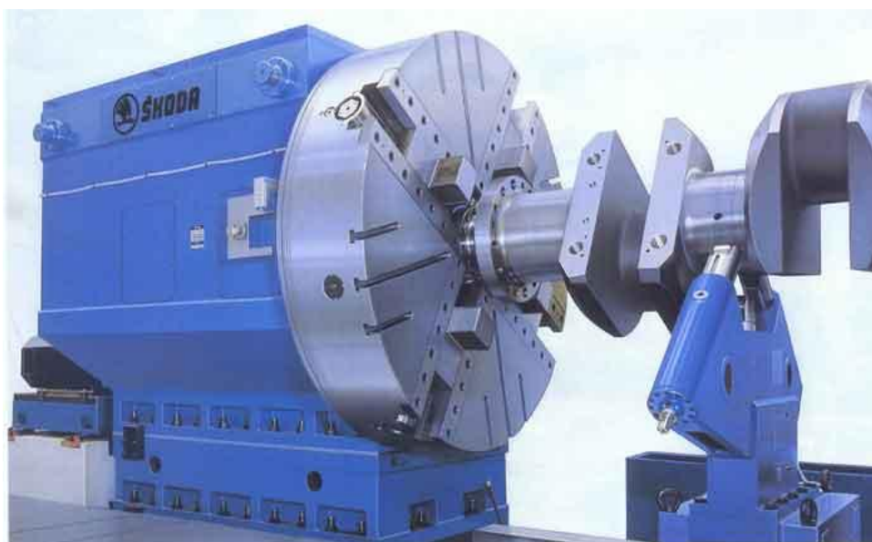
Obr. 3.54: Lícní deska soustruhu se samostatně ovládanými čelistmi[ŠMT Plzeň 2010]
