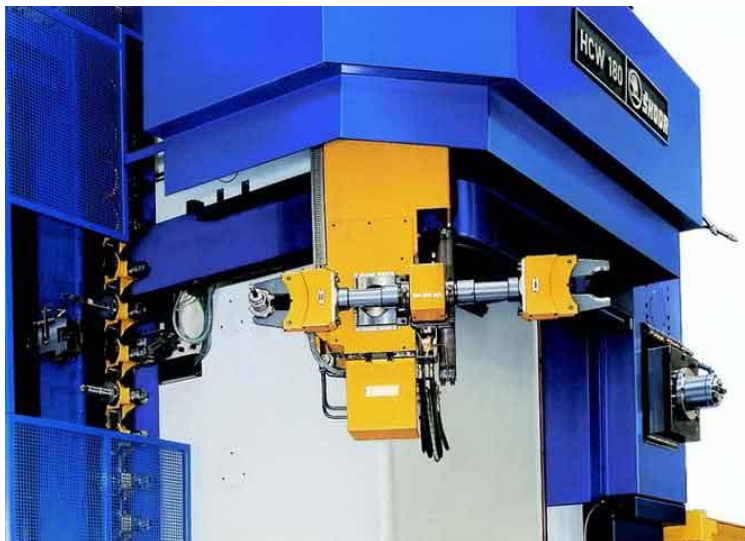
Obr. 3.57 : Část výměny nástrojů s pojízdným manipulátorem a otočným podavačem nástrojů[ŠMT Plzeň 2010]
