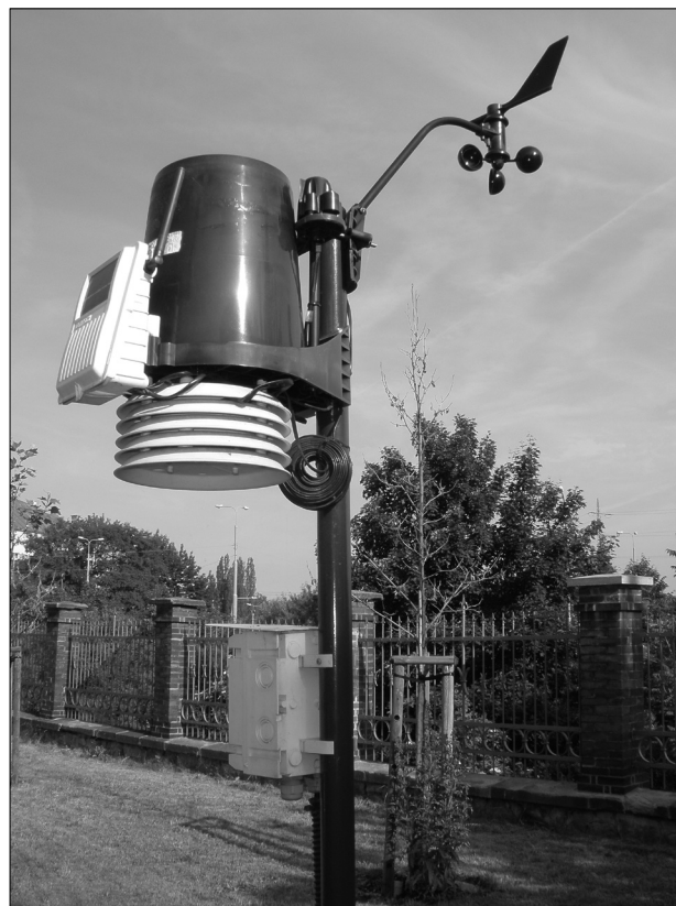
Obr. 2. Školní meteorologická stanice Vantage Pro2™ Plzeň-Veveslavínova; zdroj: foto autor
