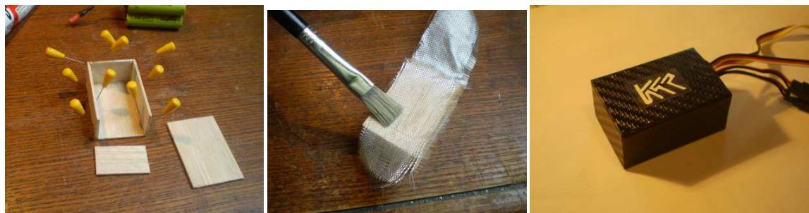
Obrázok 3 Výroba krabičky, laminovanie sklenenou tkaninou, finálny výrobok
