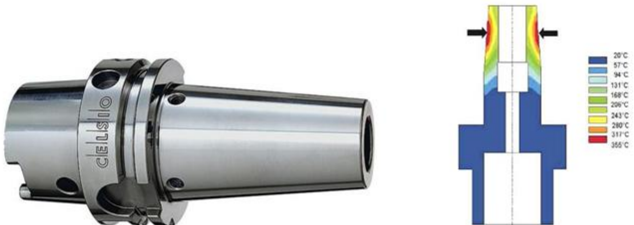
Obr. 2 Tepelný upínač a rozložení teplot na upínači [8 a 9] Fig. 2 Shrink fit tool holder and heat distribution on the tool holder [8 a 9]
